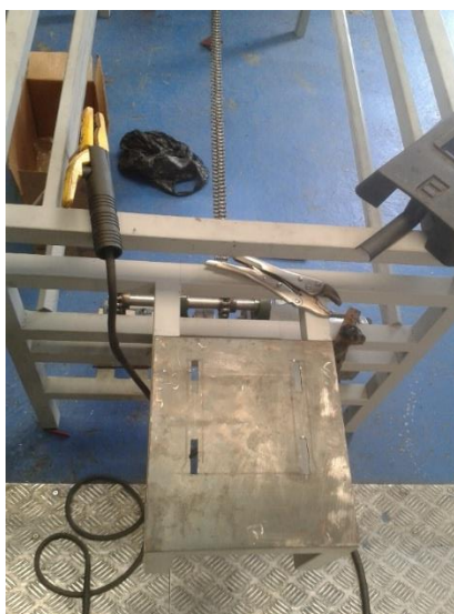
Figura 3. 8. Base de motor
