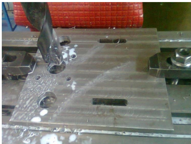
Figura 3. 7. Ranuras y taladros realizados
