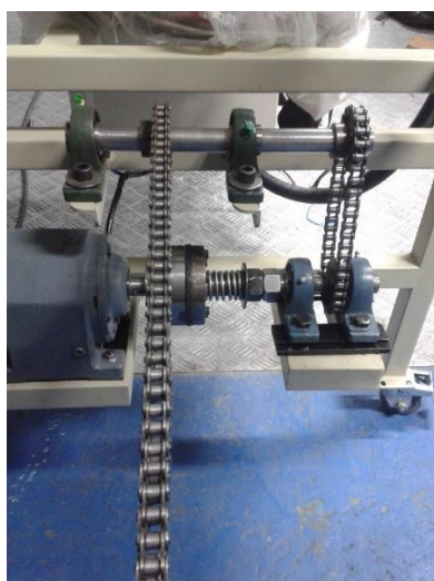
Figura 3. 20. Colocación de cadena
