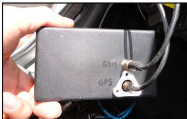
Figura 6.10. Entrada de señales de antenas GPS y GSM.
