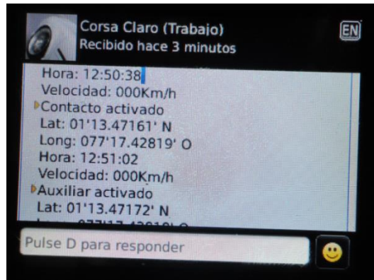
Figura 6.19. SMS de alarma por contacto activado.
