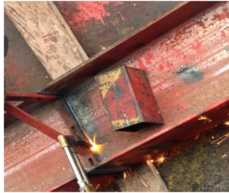
Figura 4. 4 Corte perfil IPN Elaborado por: Carrera C. & Cepeda W.
