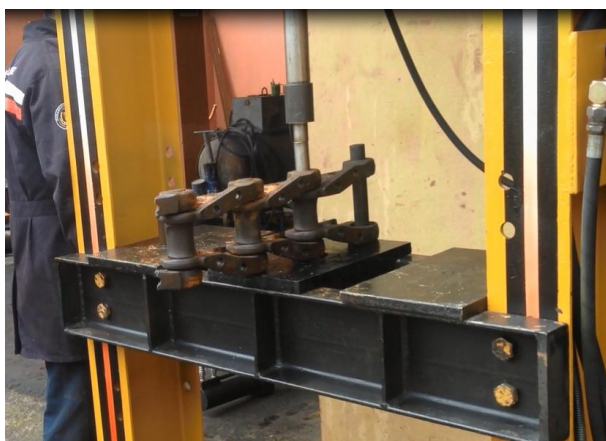
Figura 5. 1 Remoción de pines de cadena Elaborado por: Carrera C. & Cepeda W.
