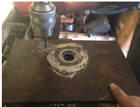
Figura 4. 61 Perforación base bomba hidráulica Elaborado por: Carrera C. & Cepeda W.
