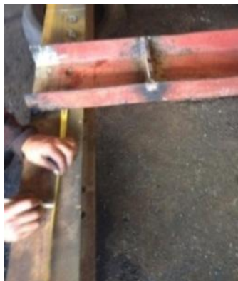
Figura 4. 23 Medida altura perfil IPN Elaborado por: Carrera C. & Cepeda W.
