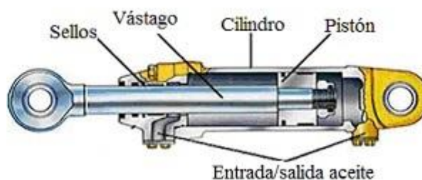
Figura 2. 32 Cilindro hidráulico de doble efecto Fuente: www.ingemecanica.com
