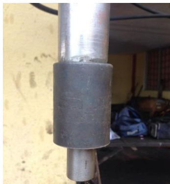
Figura 4. 56 Acople terminado Elaborado por: Carrera C. & Cepeda W.
