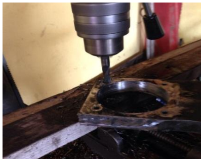
Figura 4. 50 Soporte Cilindro de 3in Elaborado por: Carrera C. & Cepeda W.
