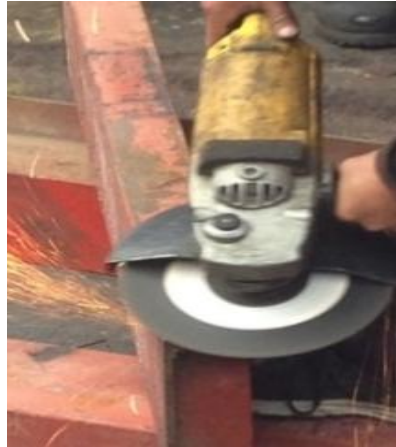
Figura 4. 18 Eliminación de rebabas Elaborado por: Carrera C. & Cepeda W.
