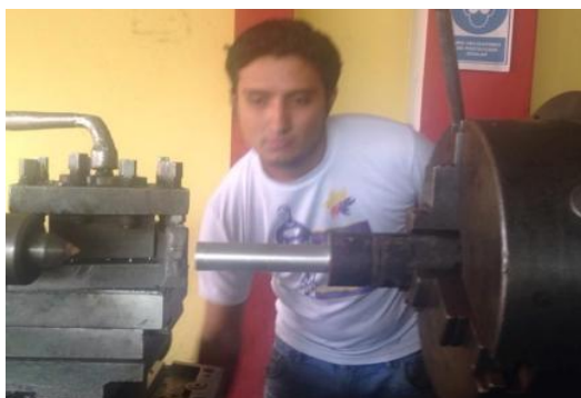
Figura 4. 54 Torneado del acople Elaborado por: Carrera C. & Cepeda W.
