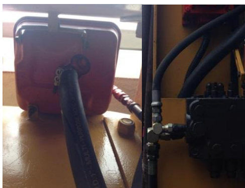
Figura 4. 86 Manguera de 1320 PSI tanque - mando hidráulico Elaborado por: Carrera C. & Cepeda W.
