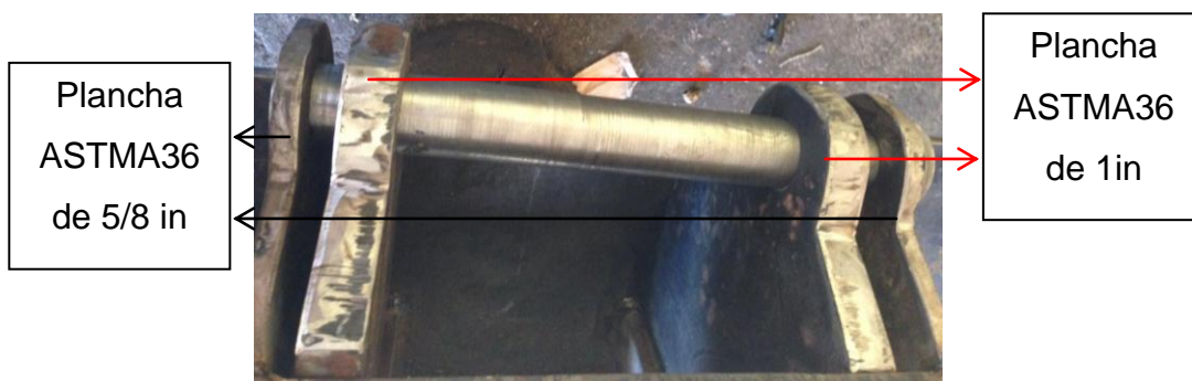
Figura 4. 47 Pasador y bases de refuerzo Elaborado por: Carrera C. & Cepeda W.
