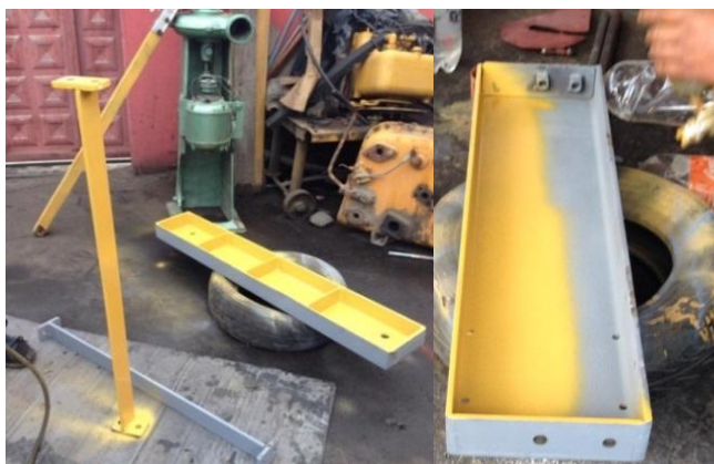
Figura 4. 78 Pintura amarillo señal RAL1003 Elaborado por: Carrera C. & Cepeda W.
