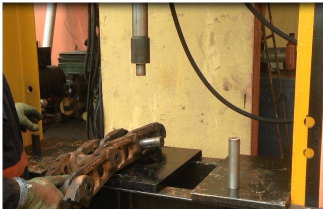
Figura 5. 2 Tiempo de remoción de pines de cadena Elaborado por: Carrera C. & Cepeda W.
