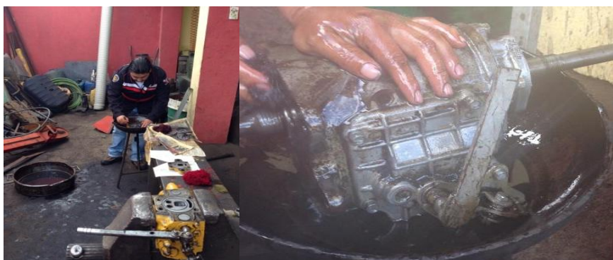
Figura 4. 74 Pulverizado y limpieza de elementos Elaborado por: Carrera C. & Cepeda W.
