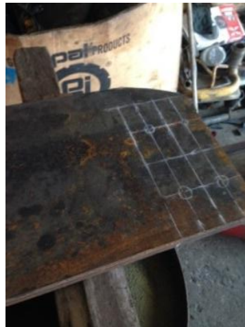
Figura 4. 8 Ubicación de perforaciones Elaborado por: Carrera C. & Cepeda W.
