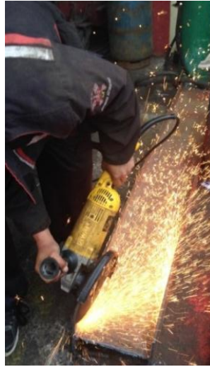
Figura 4. 7 Eliminación rebabas Elaborado por: Carrera C. & Cepeda W.
