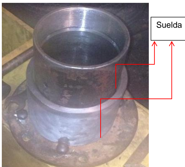
Figura 4. 41 Soldadura tubo redondo Elaborado por: Carrera C. & Cepeda W.
