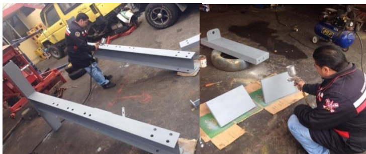
Figura 4. 76 Fondo gris Elaborado por: Carrera C. & Cepeda W.
