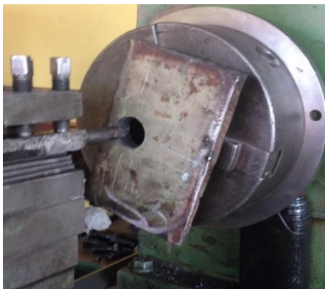
Figura 4. 46 Orificio de bases de refuerzo Elaborado por: Carrera C. & Cepeda W.
