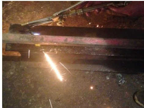
Figura 4. 63 Corte perfil IPN Elaborado por: Carrera C. & Cepeda W.
