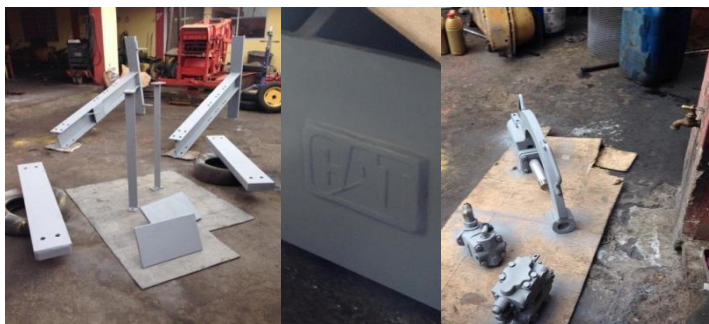
Figura 4. 77 Secado fondo gris Elaborado por: Carrera C. & Cepeda W.
