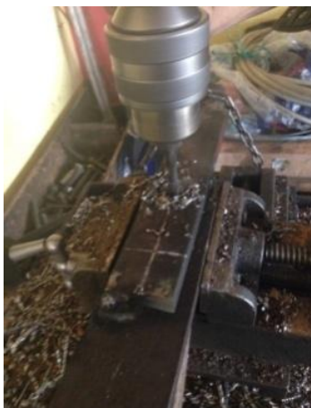
Figura 4. 65 Perforación de plancha ASTM36 de ½ in Elaborado por: Carrera C. & Cepeda W.
