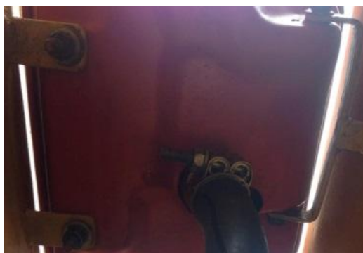
Figura 4. 70 Soporte tanque hidráulico Elaborado por: Carrera C. & Cepeda W.
