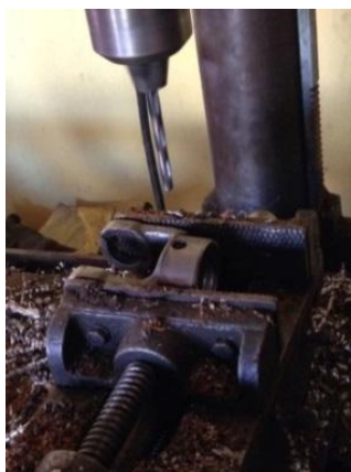
Figura 4. 71 Perforación para prisionero Elaborado por: Carrera C. & Cepeda W.
