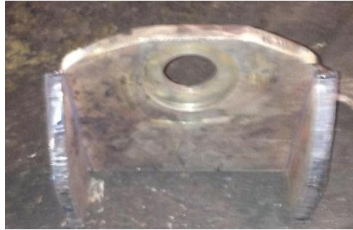
Figura 4. 62 Base bomba hidráulica Elaborado por: Carrera C. & Cepeda W.
