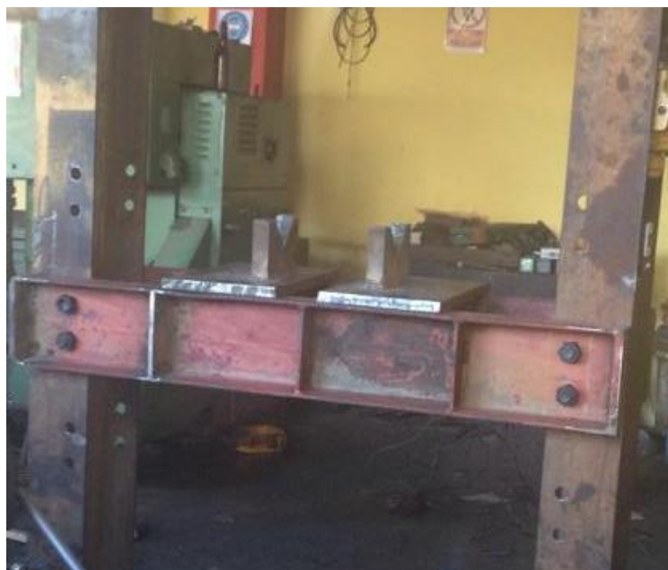
Figura 4. 27 Soporte móvil y mesa de trabajo Elaborado por: Carrera C. & Cepeda W.
