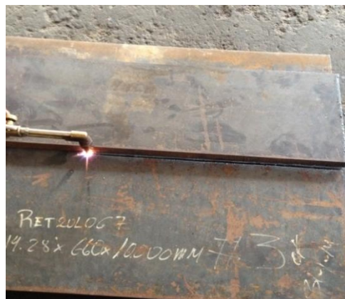
Figura 4. 5 Corte planchas ASTMA36 Elaborado por: Carrera C. & Cepeda W.
