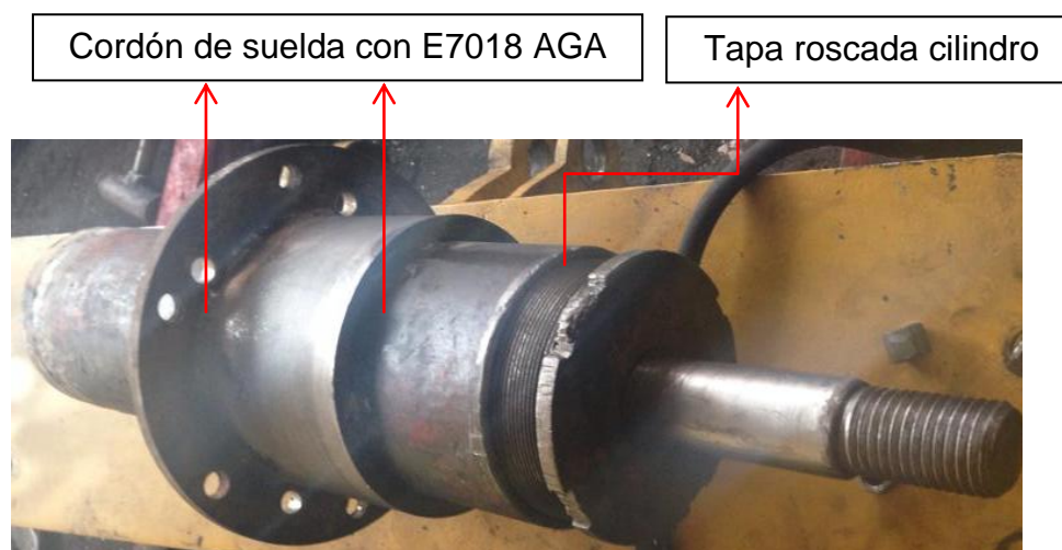
Figura 4. 43 Cilindro de doble efecto encamisado Elaborado por: Carrera C. & Cepeda W.
