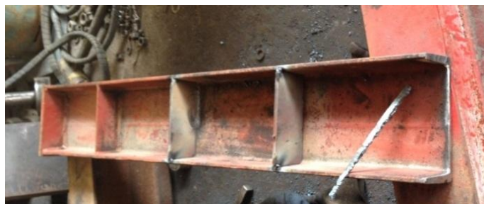
Figura 4. 17 Refuerzos perfil UPN200 Elaborado por: Carrera C. & Cepeda W.
