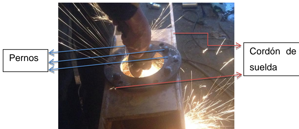
Figura 4. 40 Soldadura y rectificación de plancha ASTMA36 de 5/8 in Elaborado por: Carrera C. & Cepeda W.
