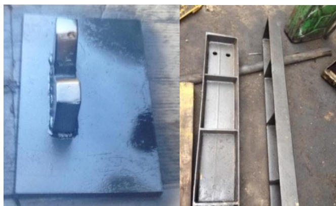
Figura 4. 80 Mesa de trabajo con pintura negro señal RAL9004 Elaborado por: Carrera C. & Cepeda W.
