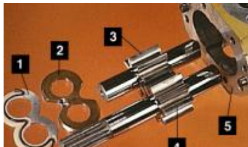
Figura 2. 18 Componentes bomba de engranajes Fuente: www.weg.net
