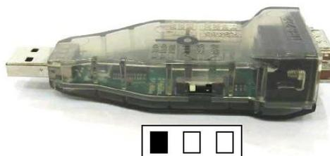
**Figura 2. 9.-** Posición del switch para modo TTL.
