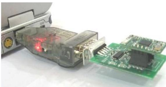
**Figura 2. 15.-** Conexión del dispositivo ZIG2Serial al ordenador.
