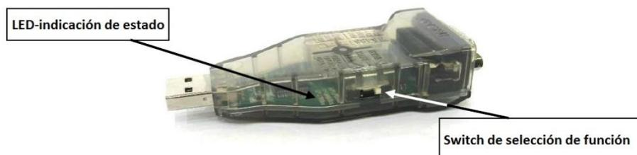
**Figura 2. 8.-** Ubicación del LED de indicación de estado y del switch de selección de función en la interfaz USB2Dynamixel.
