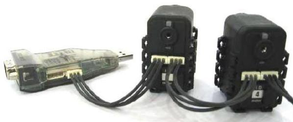
**Figura 2. 10.-** Conexión en serie de dispositivos Dynamixel serie AX.
