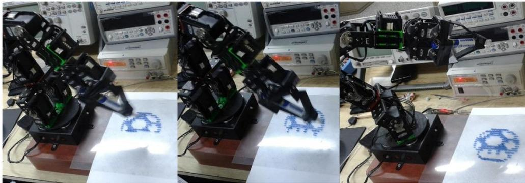
**Figura 4. 10.-** Proceso de mecanizado de un dibujo por pixeles
