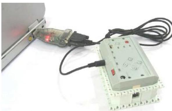
**Figura 2. 14.-** Conexión del controlador CM-5 a un ordenador.
