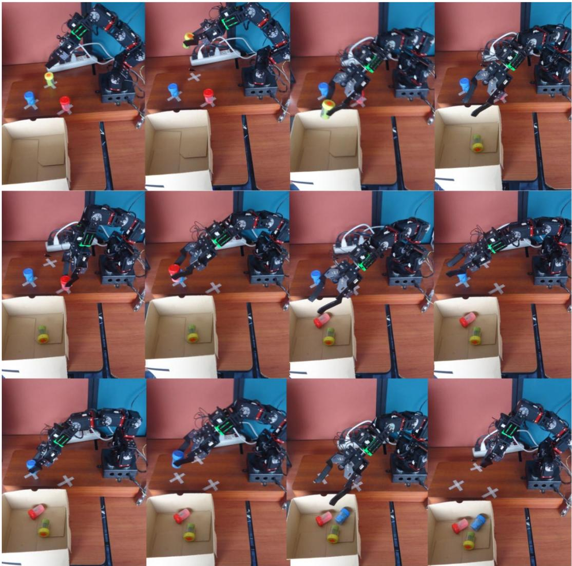
**Figura 4. 7.-** Proceso de Paletizado de 3 objetos.
