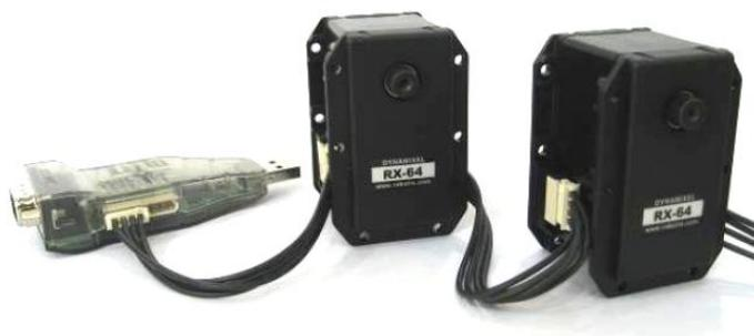
**Figura 2. 12.-** Conexión en serie de dispositivos Dynamixel serie DX/RX
