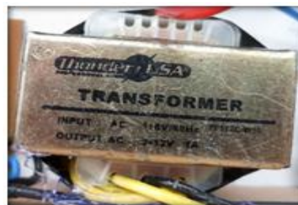
Figura 2.23: Transformador de voltaje
