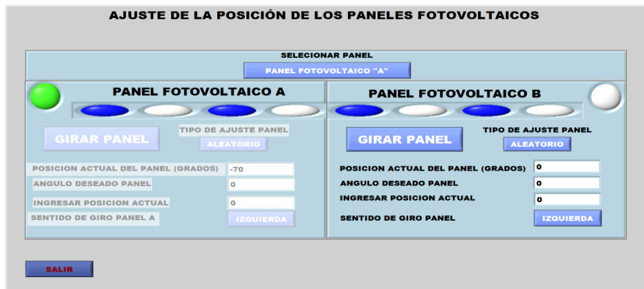
Figura 4.24: Pantalla de ajuste de la posición de los paneles fotovoltaicos
