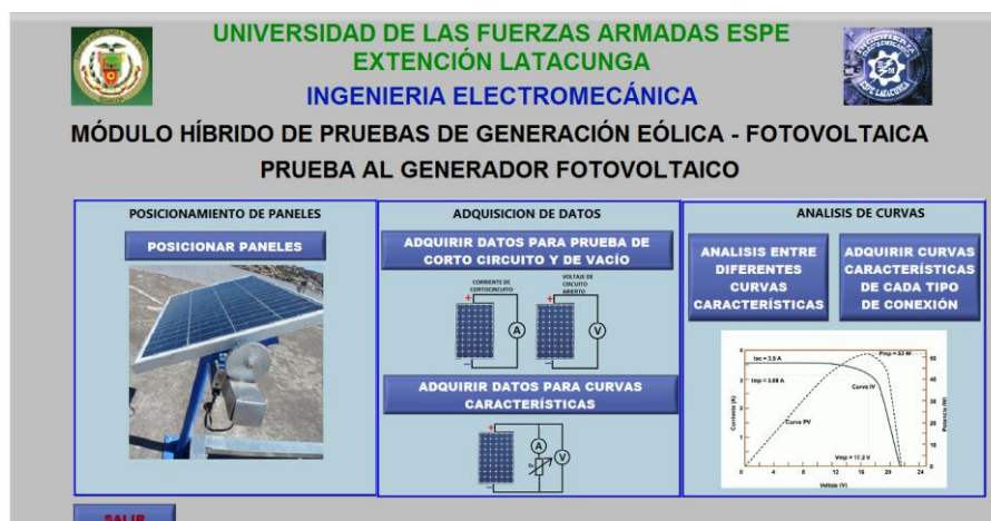
Figura 4.23: Pantalla principal de pruebas a paneles fotovoltaicos
