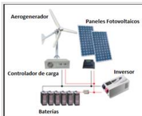
Figura 2.1: Sistema Híbrido Eólico-Fotovoltaico
