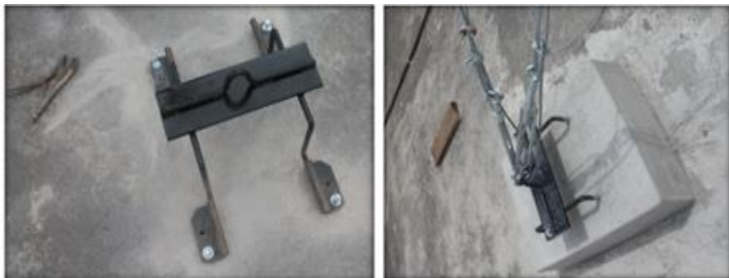
Figura 3.8: Estructura soporte de los tensores
