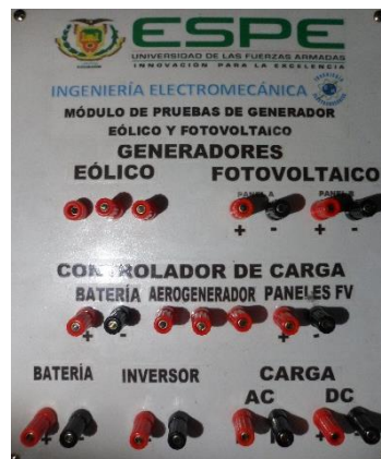
Figura 3.18: Módulo de conexión de los equipos Elaborado por: Herrera - Mullo
