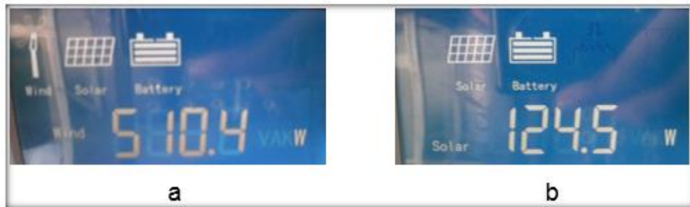
Figura 4.19: Valores de potencia de entrada al inversor a una velocidad de 6 m/s y 1100 \text{ W/m}^2 .
