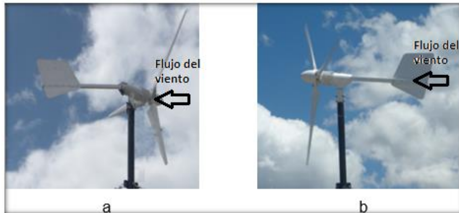
Figura 4.14: Aplicación del freno mecánico del aerogenerador.
