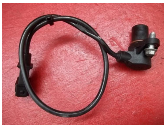
Figura. 2.14: Sensor inductivo de velocidad incluido en el motor
