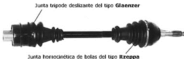
Figura. 1.8: Junta de transmisión para suspensión independiente
