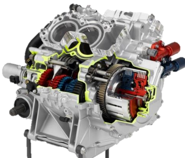
Figura. 1.4: Compacto del motor y caja de cambios de una motocicleta.
