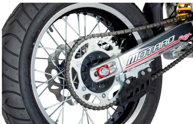
Figura. 1.2: Transmisión por cadena de motocicleta
