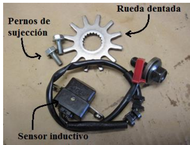
Figura. 2.10: Sensor de revoluciones y sus partes
