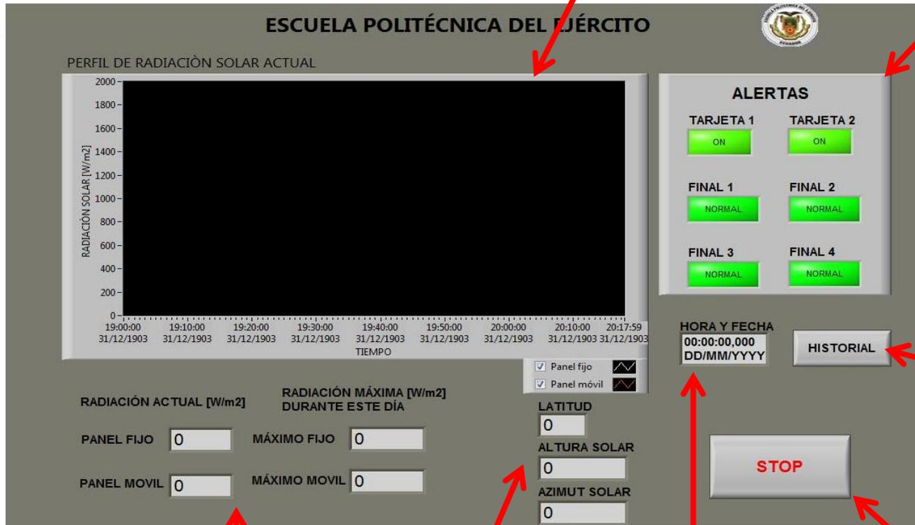
Acceso al panel secundario que indica los perfiles de radiación solar para el día que se seleccione.
