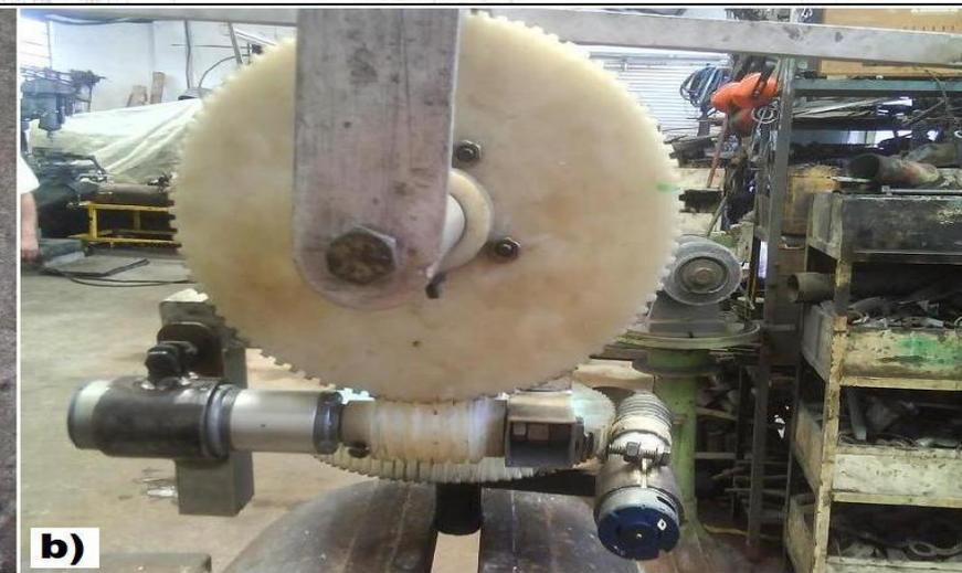
**a) Motorreductores con tornillos sin fin, b) Montaje del mecanismo de transmisión**
