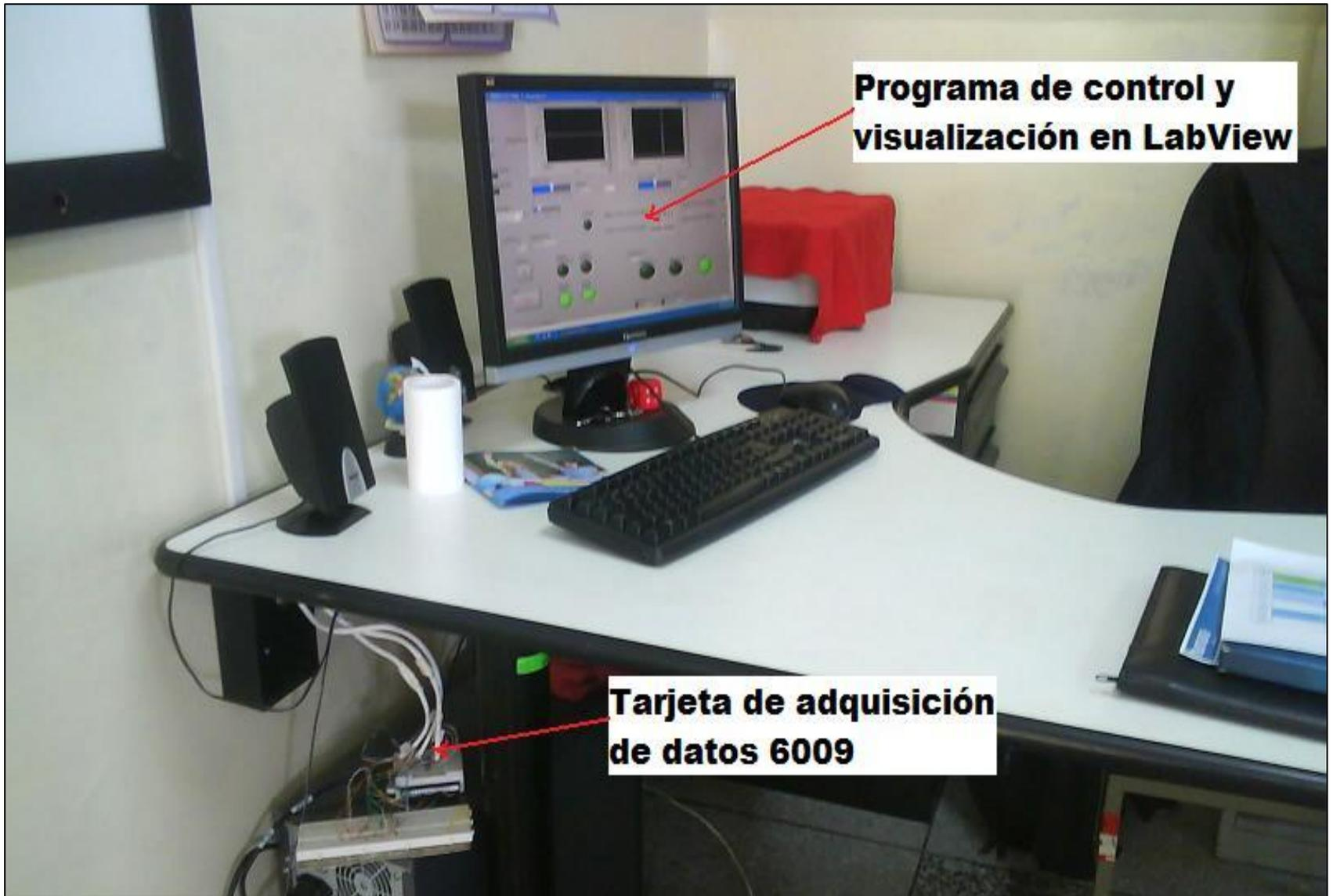
**Control del sistema con la tarjeta de adquisición de datos 6009.**
