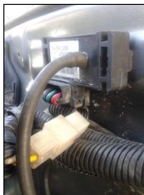
Figura 5.10: Montaje sensor MAP
