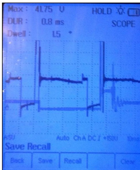
Figura 5.27: Gráfica osciloscopio dwell sistema convencional
