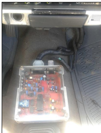
Figura. 5.7: Unidad de control electrónico (UCE) instalado.
