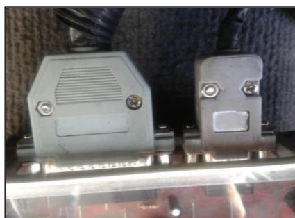
Figura 5.8: Conectores DB9 y DB25.
