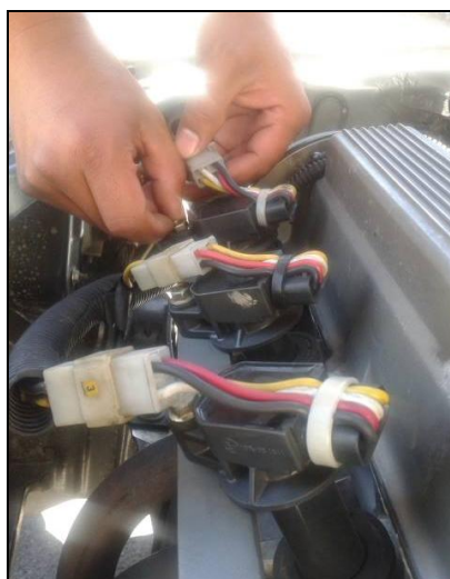
Figura 5.13: Soporte y bobinas COP
