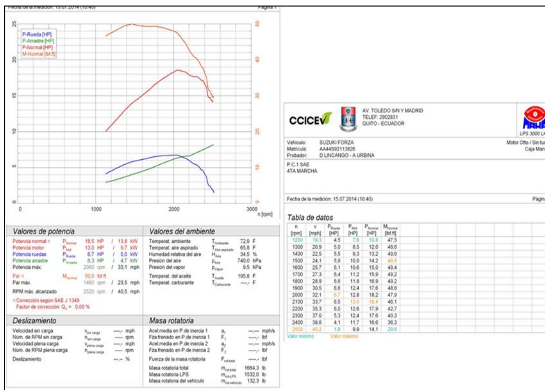
Figura 5.29: Gráficas de potencia y torque (Dinamómetro), ver anexo
