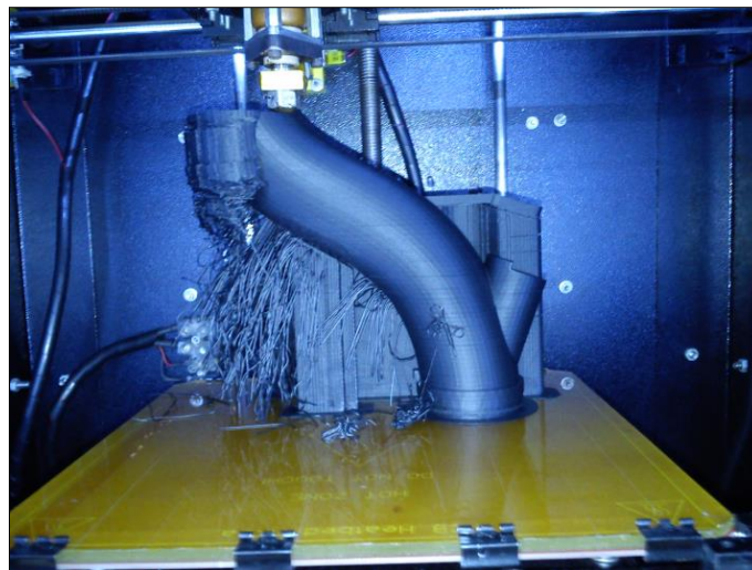
Figura 3.37 Impresión de un conducto de admisión como muestra exacta
