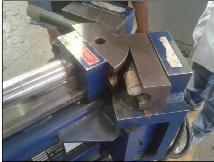
Figura 3.48 Doblado de los tubos primarios
