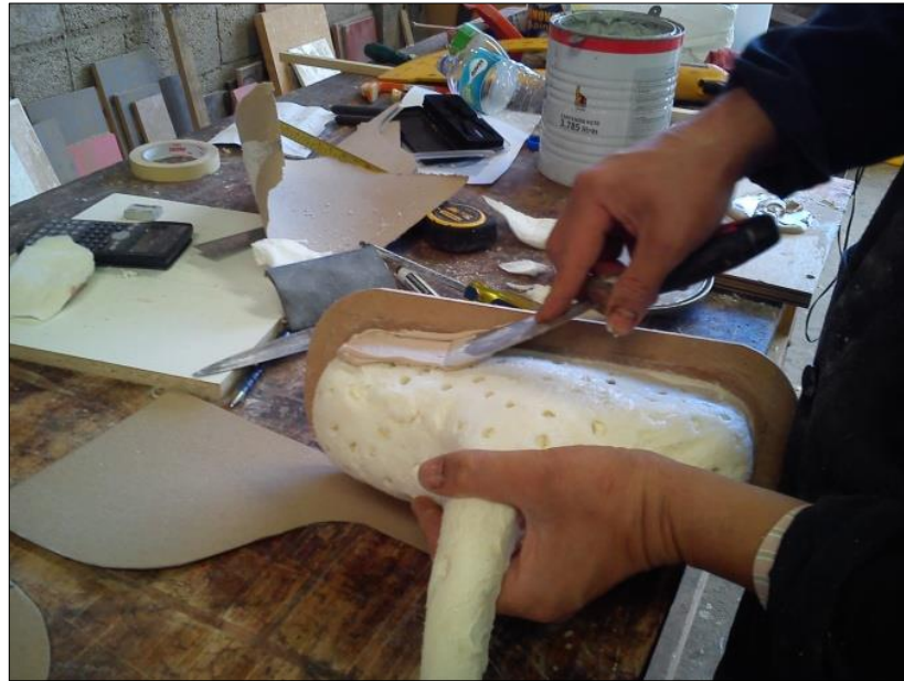
Figura 3.39 Aplicación de masilla mustang en el molde de espuma de poliuretano
