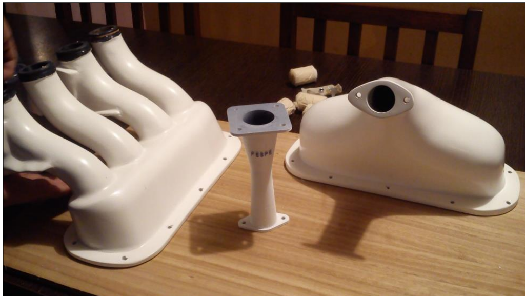
Figura 3.45 Pintado final del pleno superior, pleno inferior y el difusor
