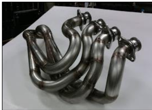
Figura 2.18. Múltiple de escape FSAE.
