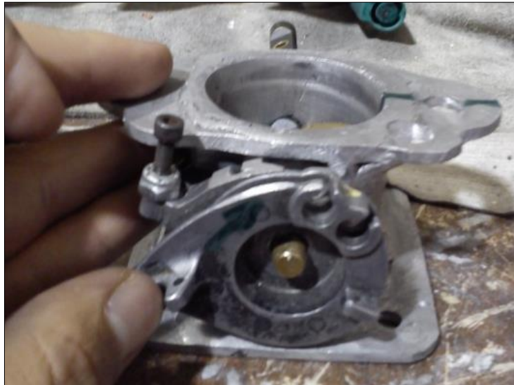
Figura 3.32 Carcasa del cuerpo de aceleración para el prototipo FSAE
