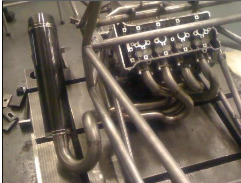
Figura 2.15 Sistema de salida de gases.
