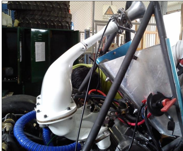
Figura 3.46 Cierre hermético del sistema mediante empaques
