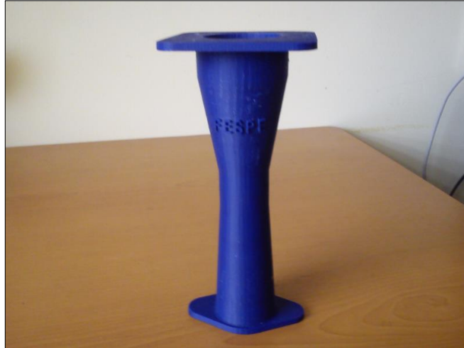
Figura 3.35 Difusor mecanizado en impresora 3D
