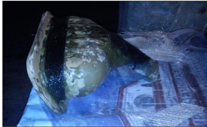
Figura 3.40 Pleno superior en fibra de vidrio
