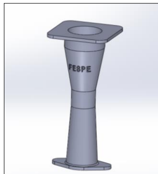
Figura 3.15 Difusor tipo Venturi con un ángulo de salida de 7 grados
