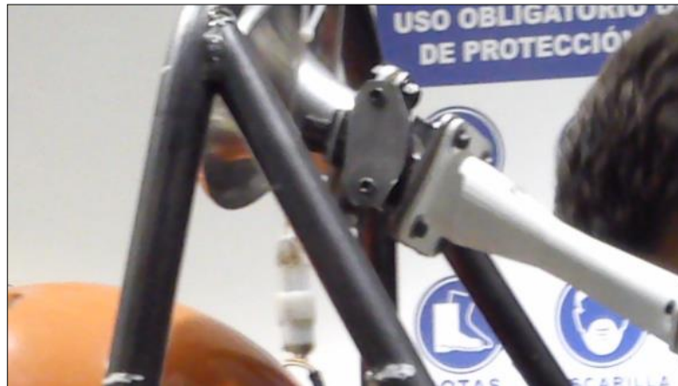
Figura 3.33 Sensor TPS montado en el cuerpo de aceleración
