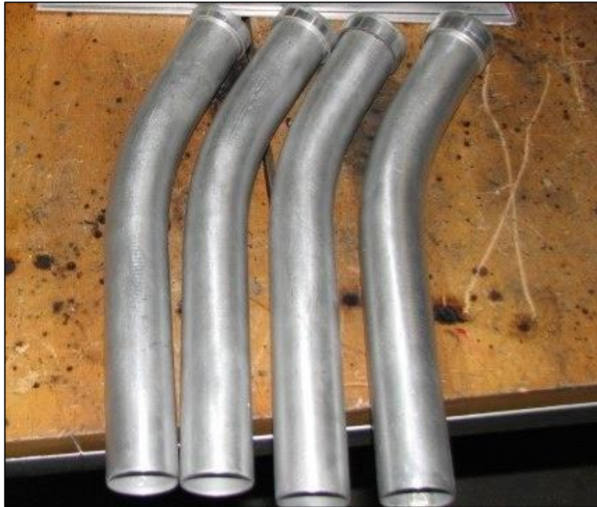
Figura 3.38 Conductos de admisión en acero inoxidable
