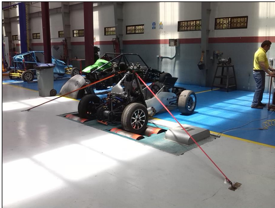
Figura 4.7 Vehículo prototipo en el dinamómetro para la prueba de potencia
