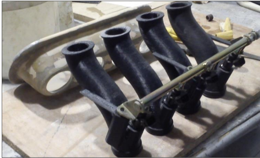
Figura 3.43 Pleno inferior con los agujeros para los conductos de admisión
