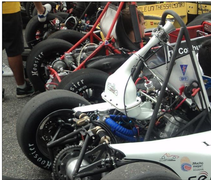
Figura 4.2 Sistema de control de ingreso de aire terminado e instalado
