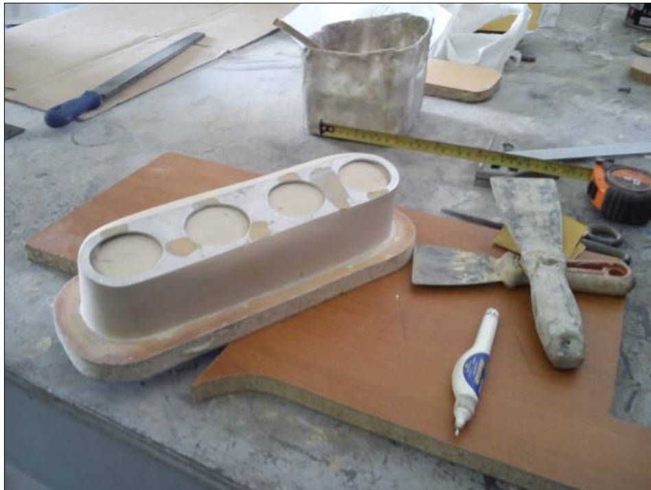
Figura 3.42 Molde negativo del pleno inferior
