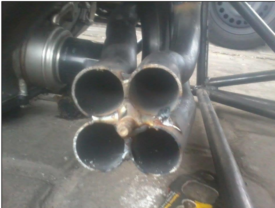
Figura 3.50 Tubos primarios soldados
