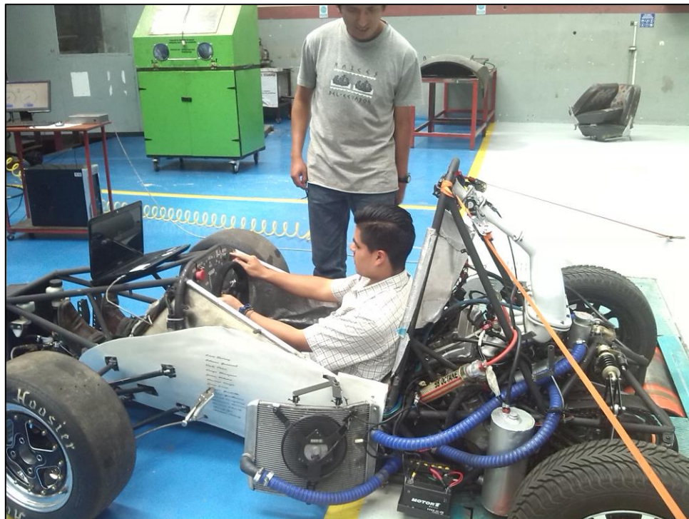
Figura 4.11 Vehículo prototipo en el dinamómetro durante la prueba torque
