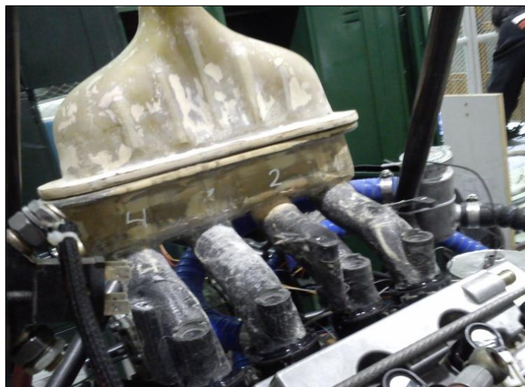
Figura 3.44 Verificación del acoplamiento del múltiple de admisión en el motor
