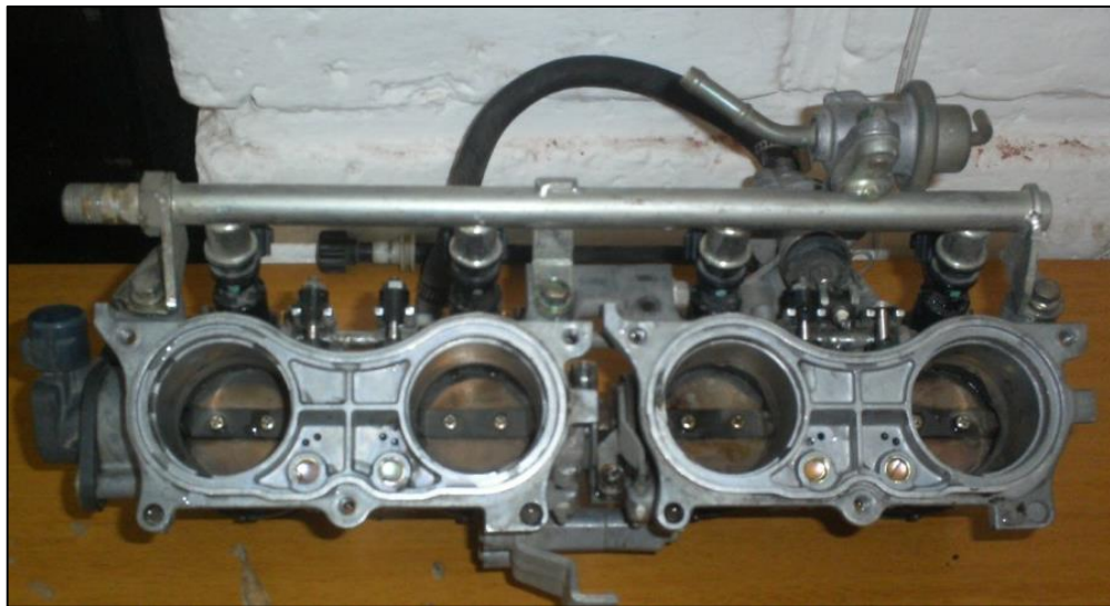
Figura 2.7. Cuerpo de aceleración Honda CBR 600 F4i
