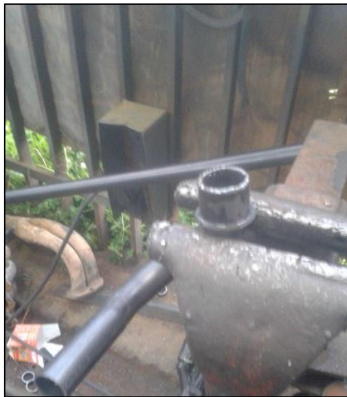
Figura 3.49 Tubos primarios con las tomas
