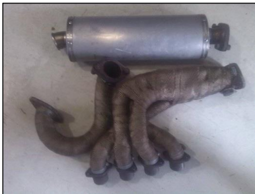
Figura 3.54 Sistema de salida de gases.
