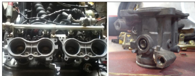
Figura 3.31 Conjunto original del cuerpo de aceleración del motor Honda CBR 600 F4i
