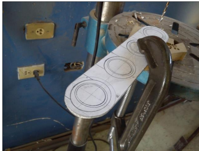
Figura 3.41 Placa de aluminio con los agujeros para los conductos de admisión
