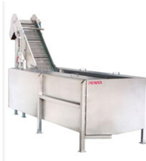
**Figura 26. Máquina de lavado**
