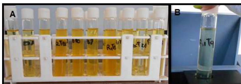
Figura 2.32 A: Muestras, en análisis, con el reactivo de Nessler, se observa su coloración amarilla. B: Colocación de muestra en el espectrofotómetro.
