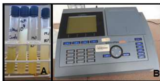
Figura 2.13 A: Medio líquido sin inoculación bacteriana y patrones de turbidez McFarland, para concentraciones de 10^7 , 10^8 y 10^9 UFC·mL -1 . B: Espectrofotómetro Spectroflex 6600.
