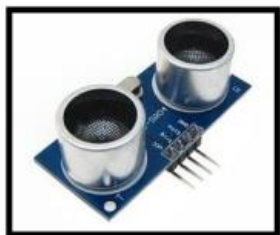
Ilustración 8 Sensor ultrasónico Arduino HC-SR04 Fuente: (Arduino, 2014)
