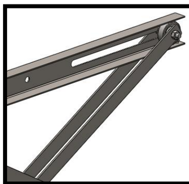
Figura 36: Ranura de deslizamiento y guía con rodamiento para el mecanismo tipo tijera
