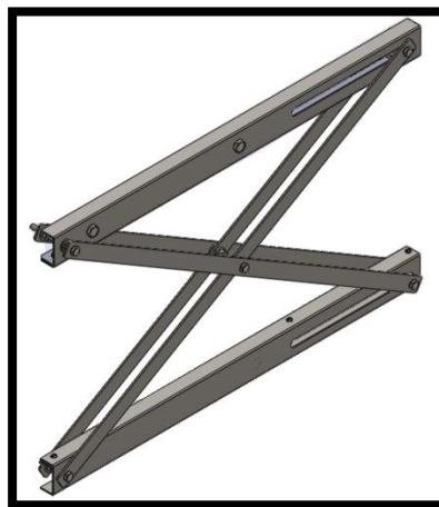
Figura 34: Disposición de los brazos del mecanismo tipo tijera
