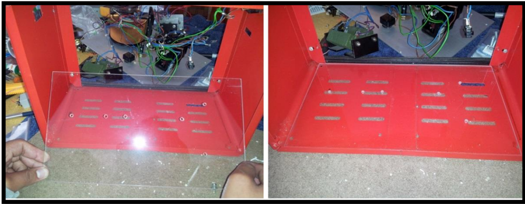
Figura 133: Instalación del acrílico de aislamiento
