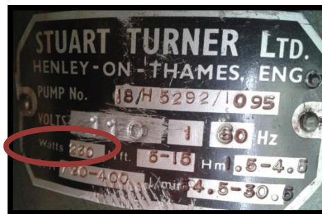
Figura 76 Placa de identificación de la bomba Stuart Turner
