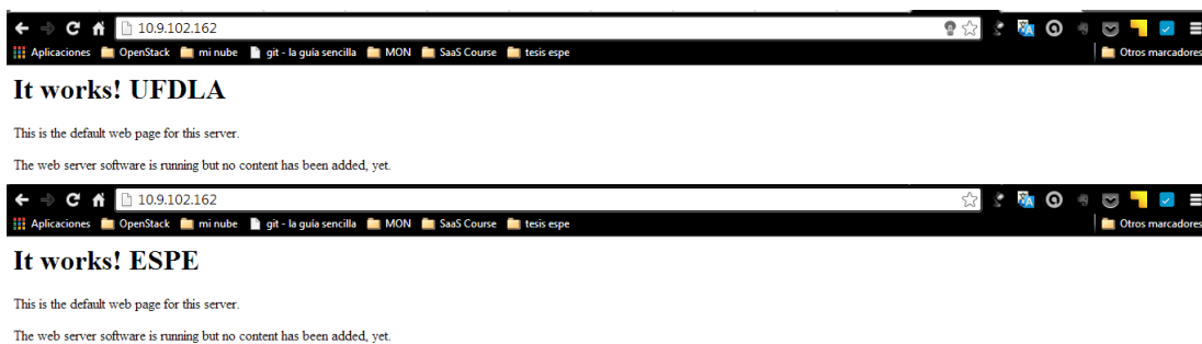
Figura 10. Balanceo de carga entre servidores web
