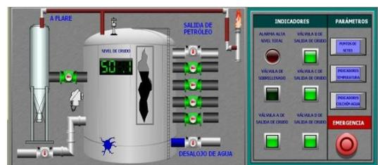
Figura 20. HMI del sistema de deshidratación.
