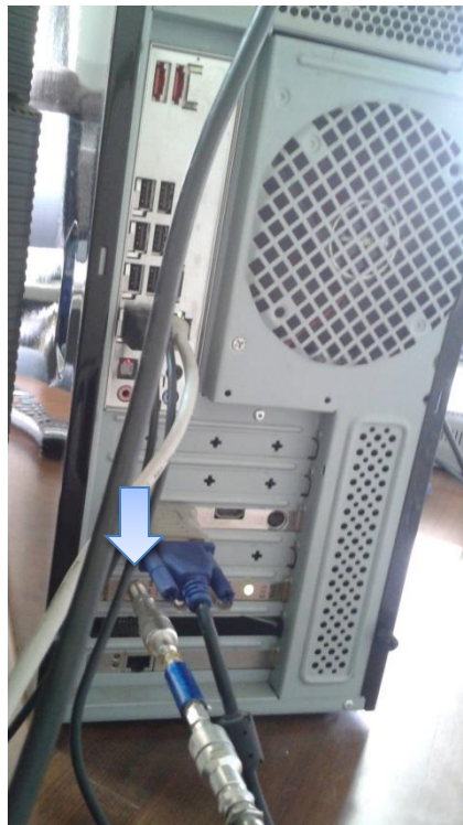
Figura 53. Conexión CPU hacia la ANTENNA IN (DTV) del Decodificador.
