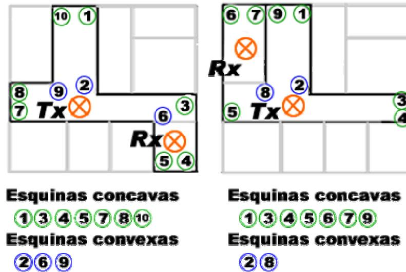
Figura. 2. 15. Esquinas convexas (o cuñas) de un cuarto y de su influencia en la determinación de las trayectorias.
