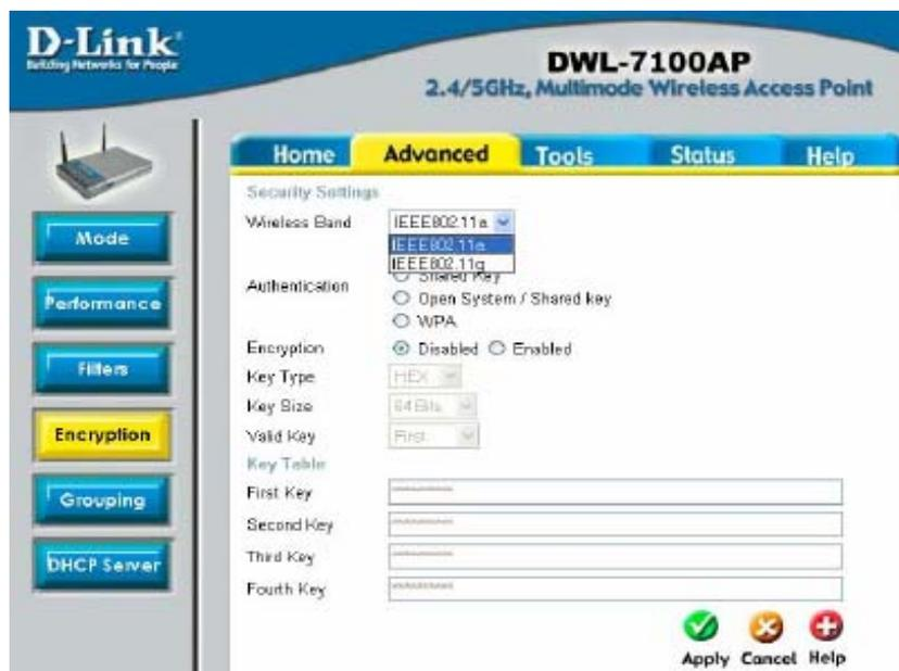
**Figura. 5. 36.** Pantalla para configuración de seguridades inalámbricas en los AP.
