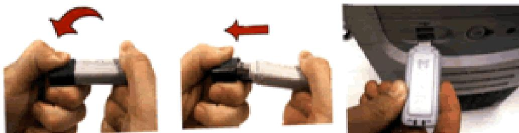
Figura. 5. 49. Instalación de tarjeta inalámbrica USB, DWL-G122.
