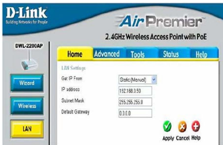
Figura. 5. 34. Pantalla para configuraciones LAN en el DWL – 2200.
