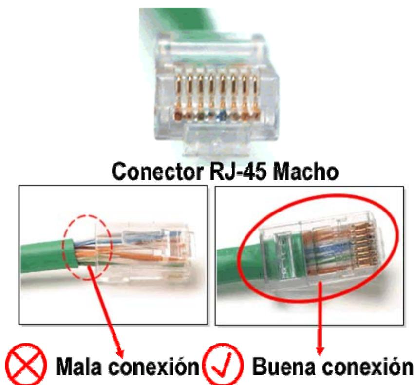
Figura. 5. 20. Patch cord con conectores RJ-45 macho, Norma EIA/TIA 568-B.
