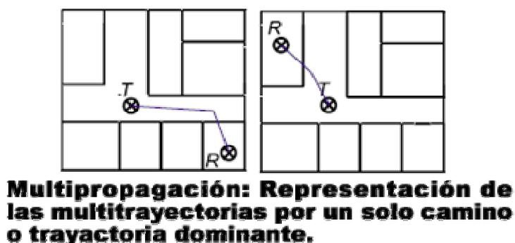
Figura. 2. 11. Representación de multitrayectorias a través de un camino dominante.
