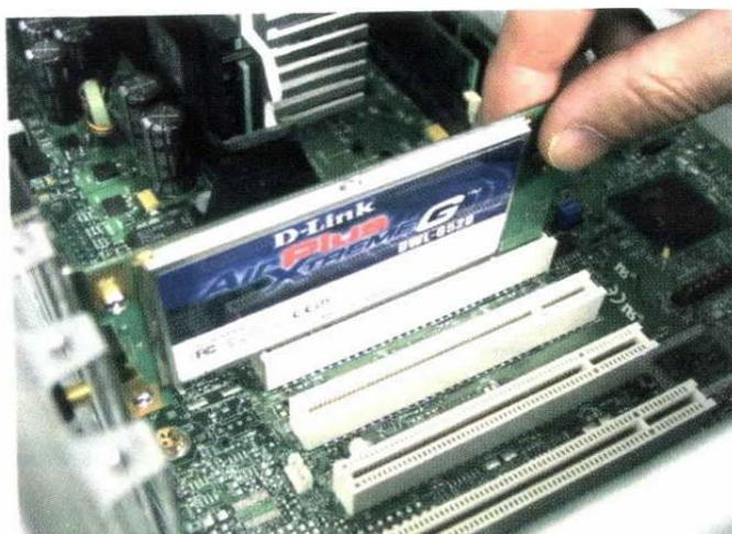
Figura. 5. 48. Instalación de tarjeta inalámbrica PCI, DWL-G520, en un desktop.
