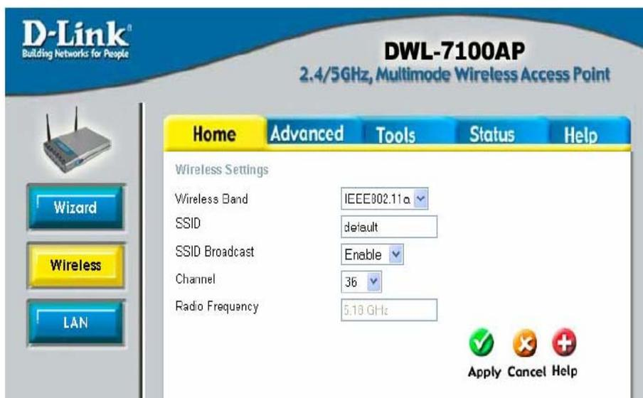
Figura. 5. 30. Pantalla para configuración de WirelessLAN del AP DWL-7100AP.
