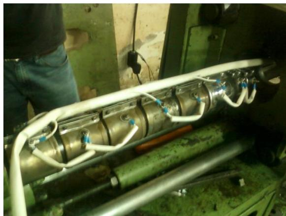
**Figura 216. Montaje de las niquelinas en cañón de inyección.**
