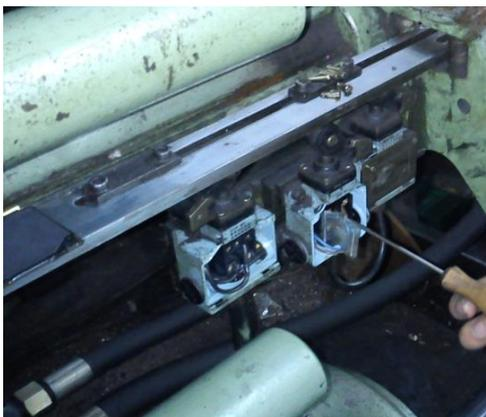
**Figura 55. Conexiones de finales de carrera.**
