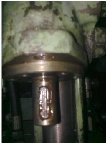
**Figura 101. Eje del motor hidráulico y su chavetero.**
