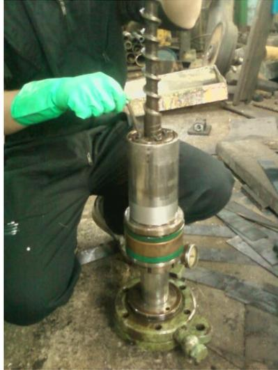
**Figura 106. Pistón de inyección y tornillo recíprocante.**
