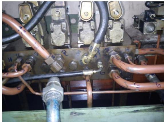
**Figura 114. Identificación conexiones en manifold.**
