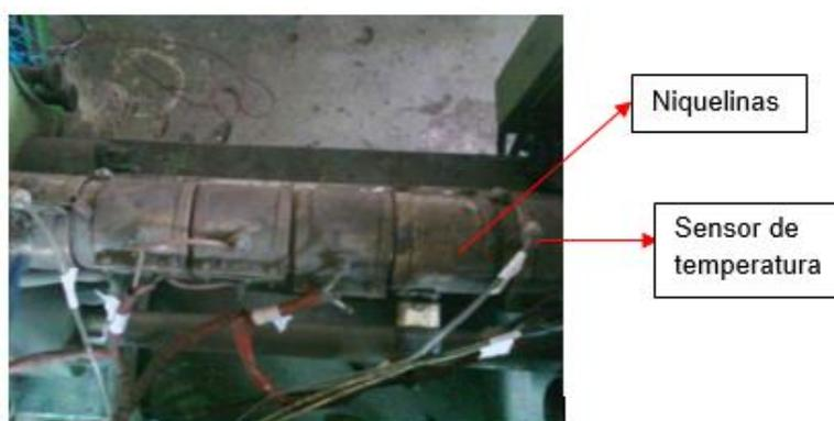
**Figura 5. Niquelinas de calentamiento para la boquilla.**
