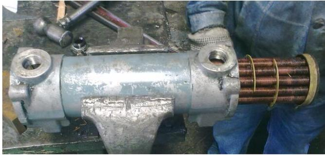
**Figura 89. Intercambiador de calor de la máquina de inyección.**
