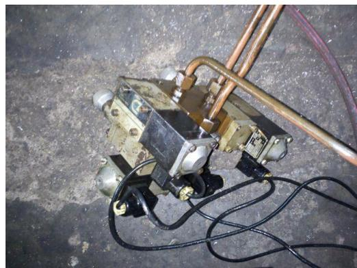
**Figura 75. Conjunto de válvulas reguladoras y piloto desmontada.**
