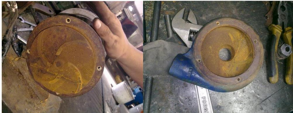
**Figura 134. Interior de la bomba de agua.**
