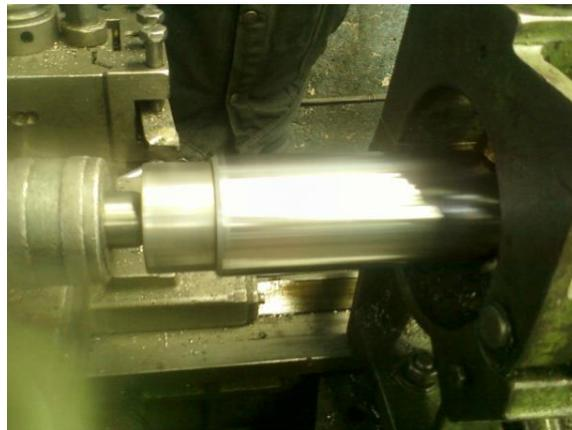
**Figura 107. Refrentado del pistón de inyección.**
