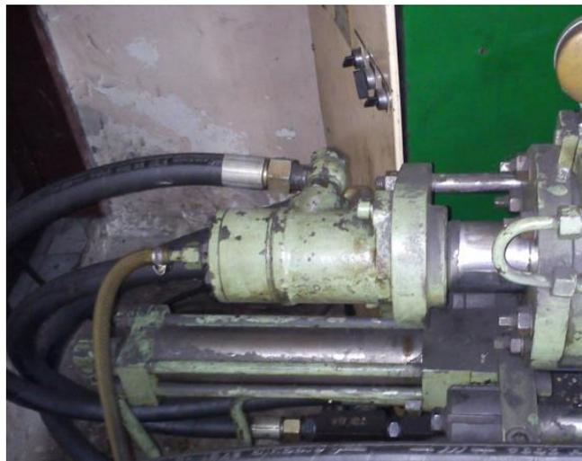
**Figura 64. Motor hidráulico**
