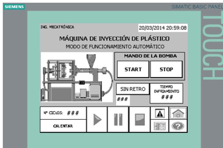
**Figura 239. Pantalla de funcionamiento automático.**
