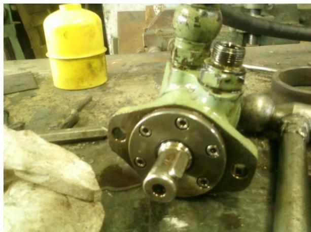
**Figura 103. Eje de motor hidráulico luego de reparación.**
