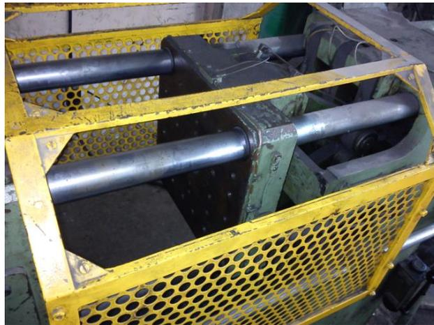
**Figura 67. Mecanismo de apertura y cierre de moldes**
