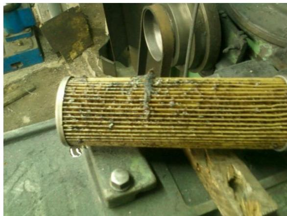
**Figura 115. Estado del filtro de aceite antes de su mantenimiento.**
