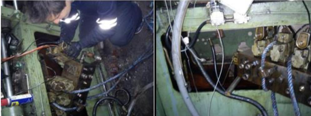
**Figura 116. Mantenimiento del manifold**
