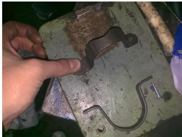
**Figura 138. Base y abrazaderas del distribuidor.**
