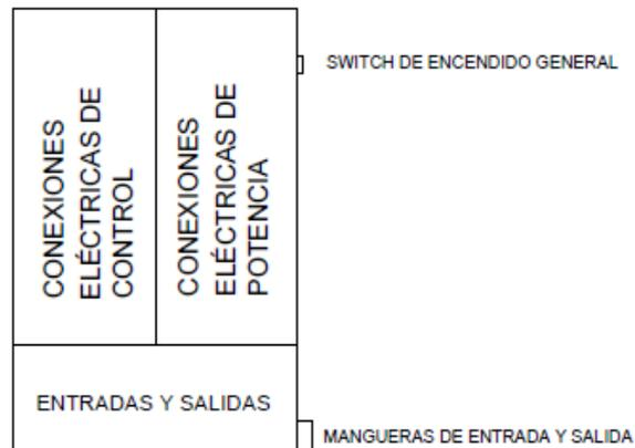
**Figura 187. Disposición de elementos en el gabinete según tipo de conexiones.**
