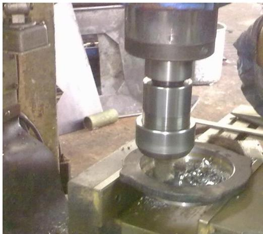
**Figura 141. Elaboración de las nuevas tapas del intercambiador.**
