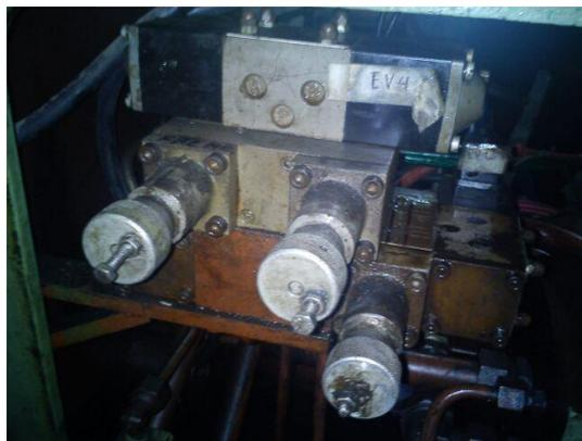
**Figura 74. Conjunto de válvulas reguladora y piloto montada**
