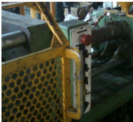
**Figura 59. Mandos locales de la máquina inyectora.**
