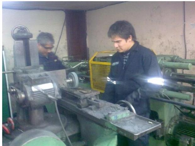
**Figura 102. Proceso de rectificado de la chaveta.**
