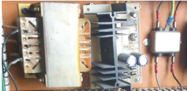
**Figura 54. Transformador, tarjeta rectificadora y filtro.**
