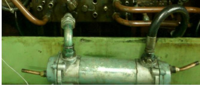
**Figura 70. Intercambiador de calor de la inyectora.**
