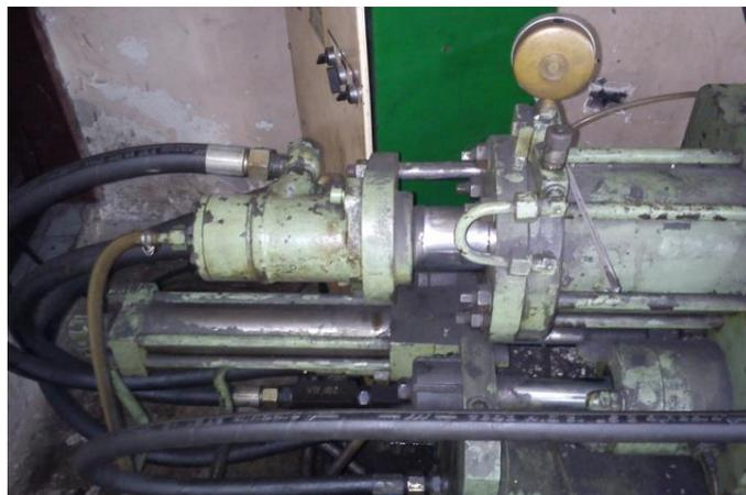
**Figura 79. Motor de carga y pistón de inyección**
