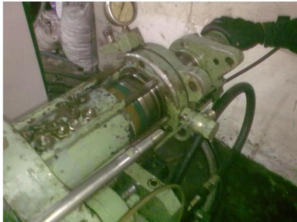
**Figura 105. Desprendimiento del motor y pistón del soporte.**
