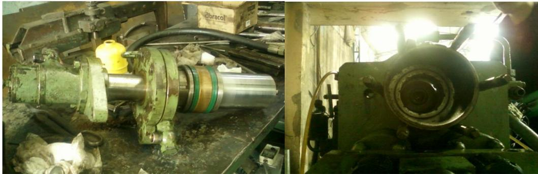
**Figura 104. Motor hidráulico y pistón de inyección.**
