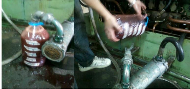
**Figura 122. Determinación del caudal de aceite a través del intercambiador.**
