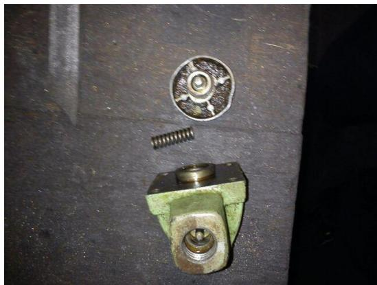
**Figura 111. Válvulas reguladoras de presión**
