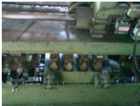
**Figura 73. Manifold y reguladores de presión.**
