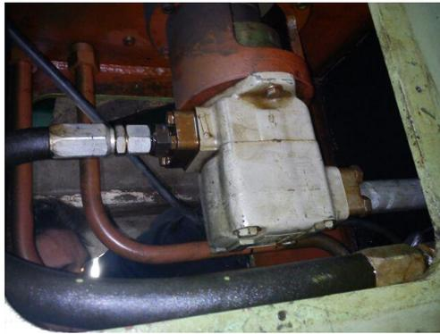
**Figura 72. Bomba hidráulica.**
