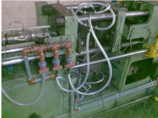
**Figura 139. Distribuidor montado en la máquina de inyección.**
