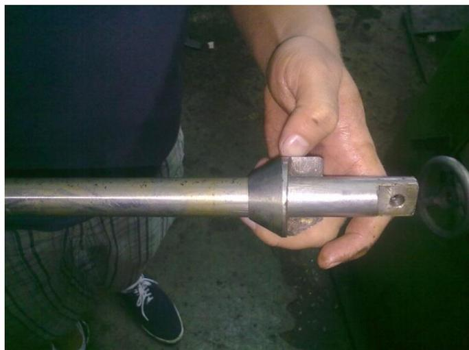
**Figura 109. Daños en el eje de regulación de finales de carrera**
