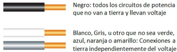
**Figura 191. Colores de cables utilizados para potencia.**
