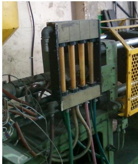
**Figura 71. Indicadores de temperatura de refrigerante.**
