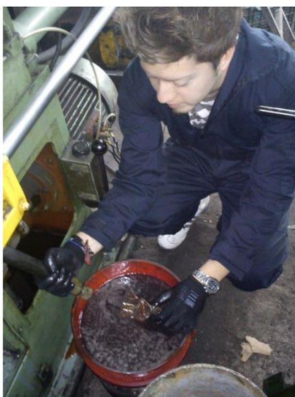
**Figura 112. Filtrado del aceite hidráulico.**
