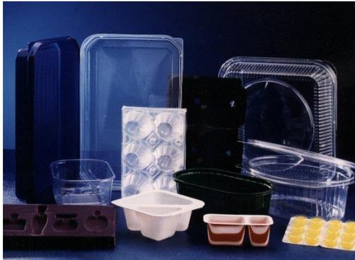
**Figura 21. Productos elaborados por termoconformado.**
