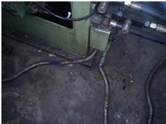
**Figura 52. Mangueras para cables de electroválvulas.**
