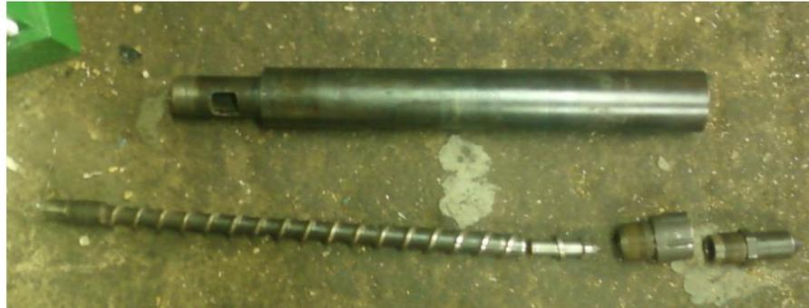
**Figura 63. Cañón, tornillo y boquilla.**
