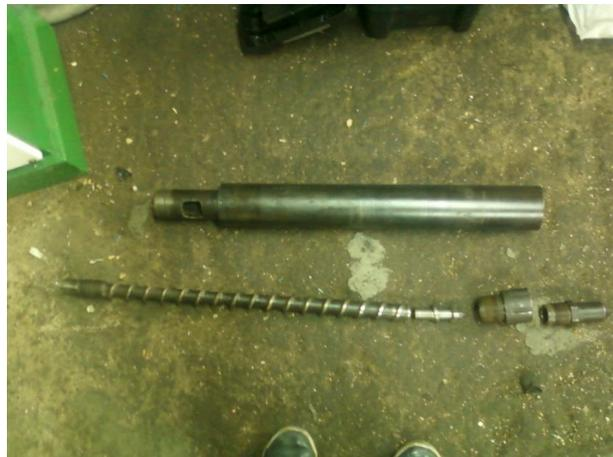
**Figura 97. Cañón, tornillo, válvula antirretorno y boquilla.**
