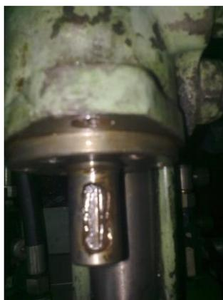
**Figura 94. Chavetero del eje del motor hidráulico.**
