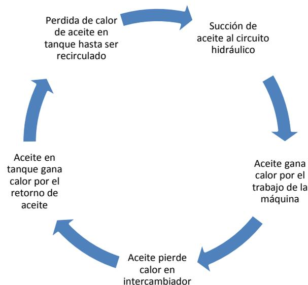
**Figura 118. Ciclo del aceite hidráulico en la máquina de inyección.**
