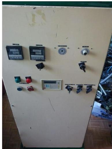
**Figura 82. Panel de control de la máquina de inyección.**
