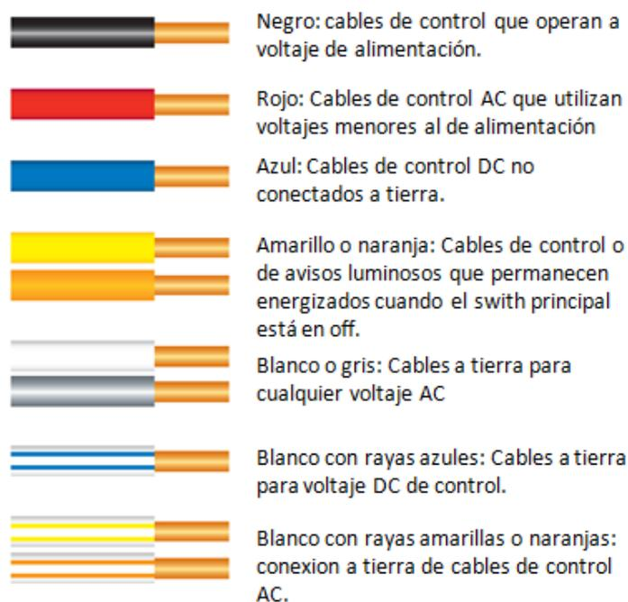
**Figura 192. Colores de cables recomendados para circuitos de control.**
