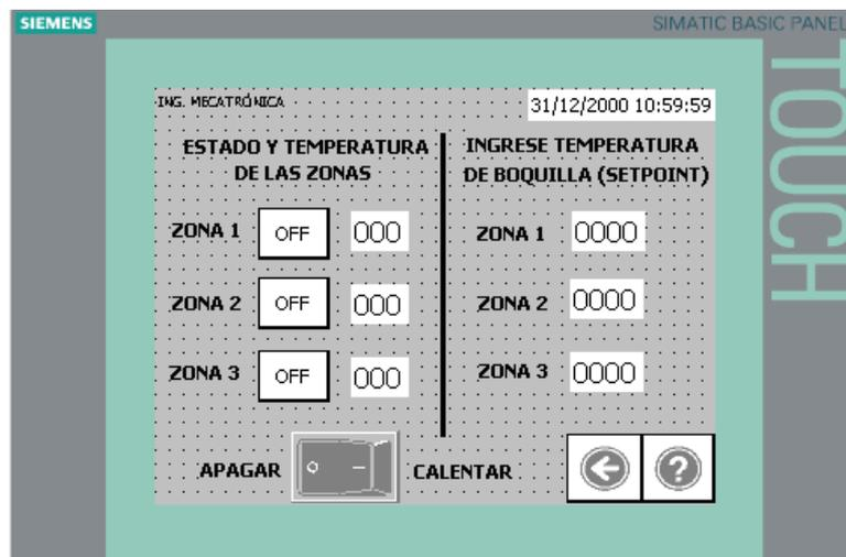
Figura 241. Pantalla de configuración de temperaturas.
