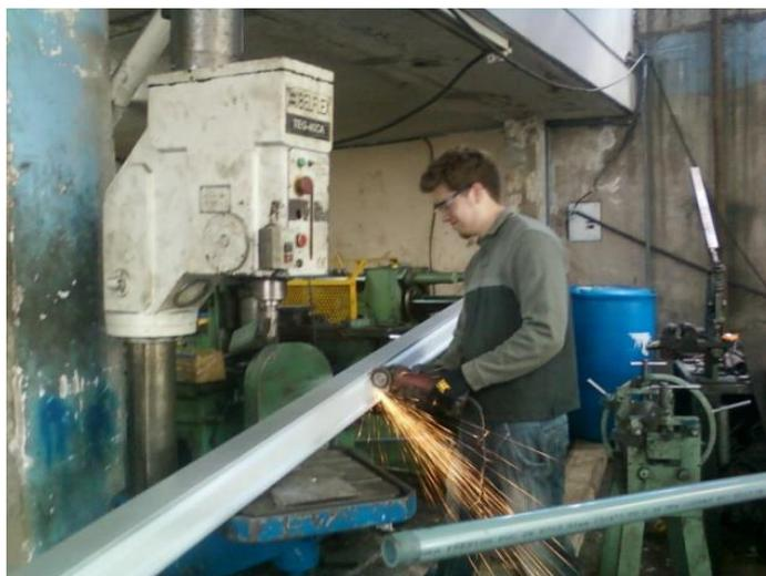
**Figura 145. Corte de canales para implementación.**
