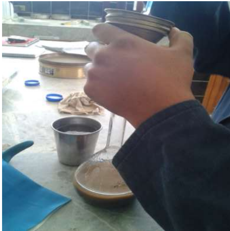
Figura 4.12 Introducción de la muestra al picnómetro (Autores)
