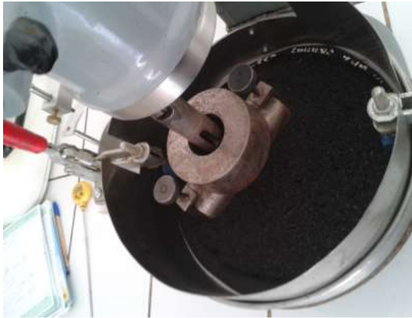
Figura 4.27 Maquina usada para el ensayo de abrasión en húmedo (Autores)
