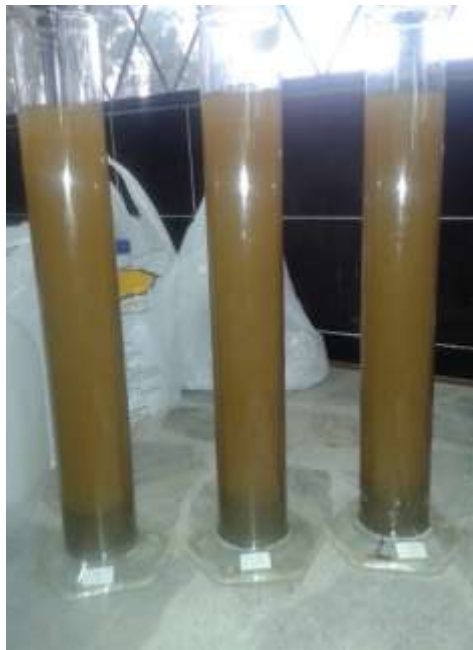
Figura 4.15 Material lavado en la probeta graduada (Autores)
