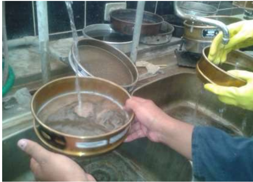
Figura 4.13 Tamizado del material por lavado (Autores)
