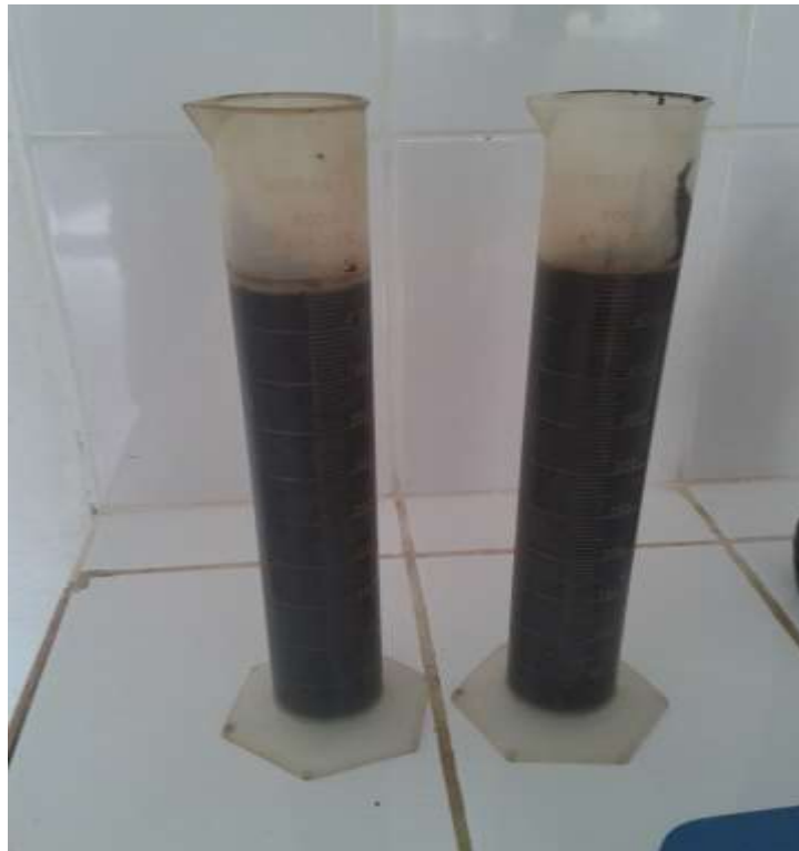
Figura 4.34 Muestra de emulsión asfáltica en probetas de ensayo (Autores)
