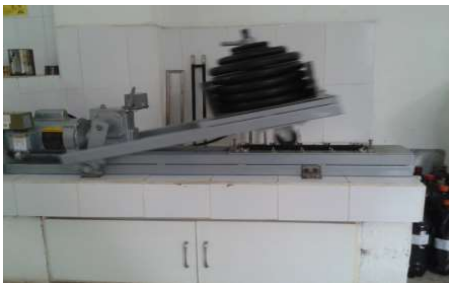
Figura 4.31 especímenes en la máquina de rueda cargada (Autores)
