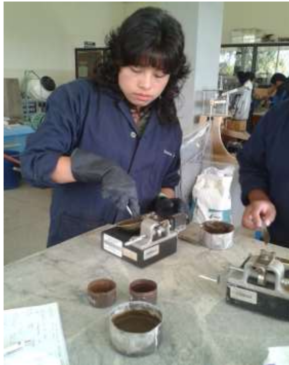
Figura 4.16 Realización de ensayos de límites de consistencia (Autores)
