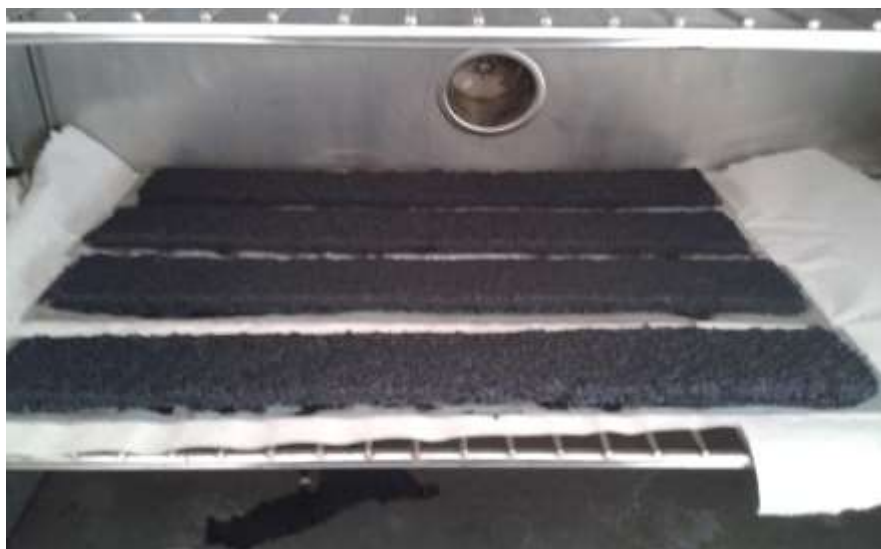
Figura 4.30 Colocación de los especímenes en el horno a 60 °C (Autores)
