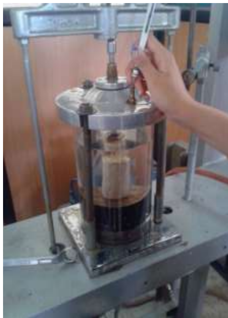
Figura 4.21 Muestra tallada en cámara del triaxial (Autores)
