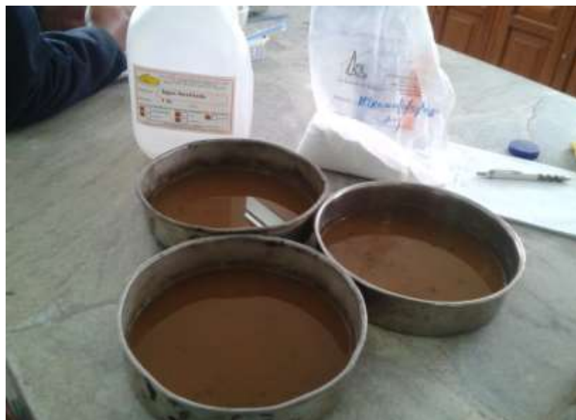
Figura 4.14 Muestras de suelo con agua destilada y anti floculantes (Autores)
