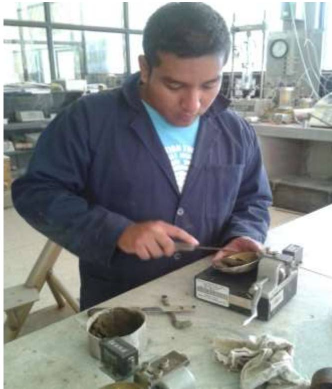
Figura 4.17 Realización de ensayos de límites de consistencia (Autores)
