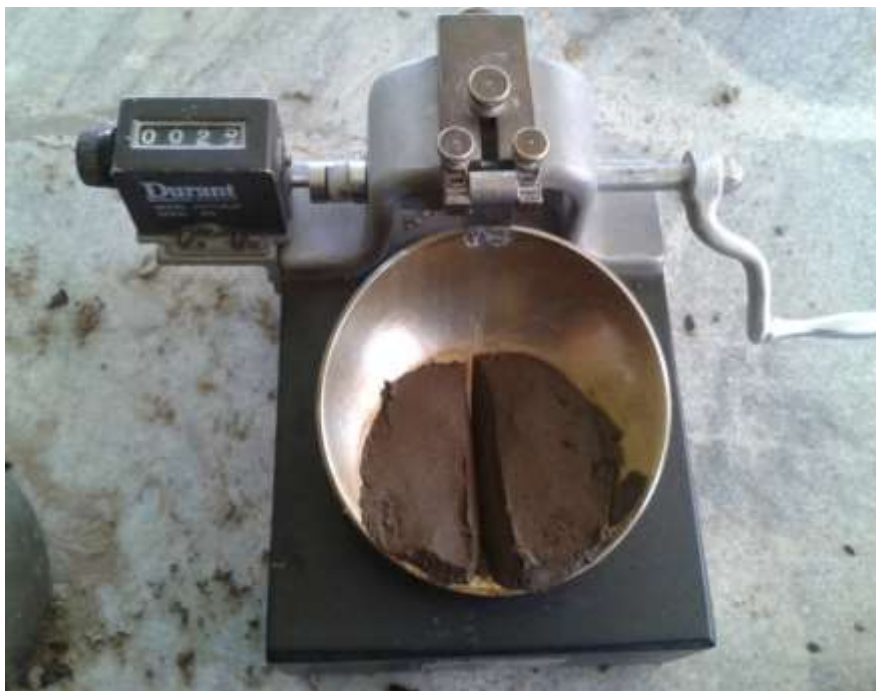
Figura 4.18 Copa de Casagrande con muestra de suelo (Autores)
