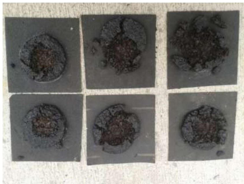
Figura 4.29 Muestras del después del ensayo de cohesión (Autores)
