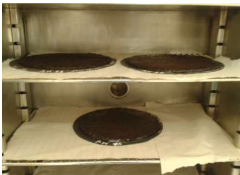
Figura 4.26 Muestras en el horno a 60°C (Autores)
