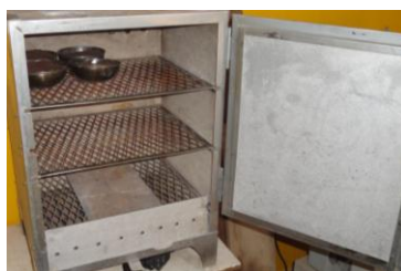
Figura 2.77: Determinación del Contenido de Humedad Elaborado por Capt. Diego López
