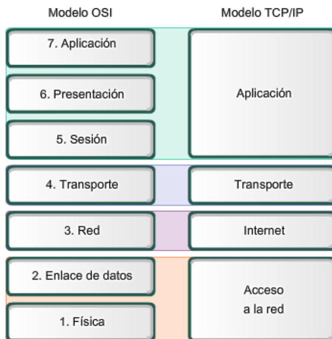
Figura 1.- Semejanzas entre el Modelo OSI y el TCP/IP
