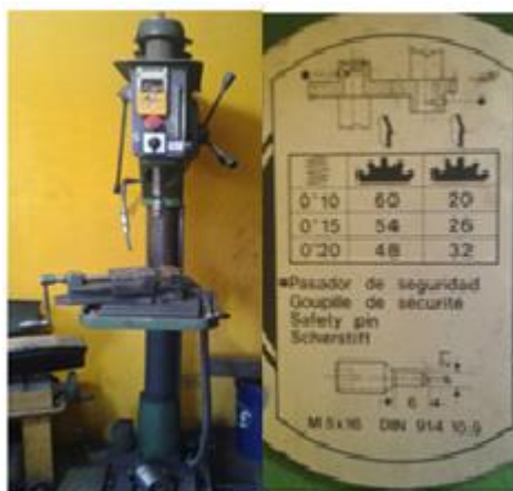
Figura 48. Herramientas de taladrado: taladro de pedestal
