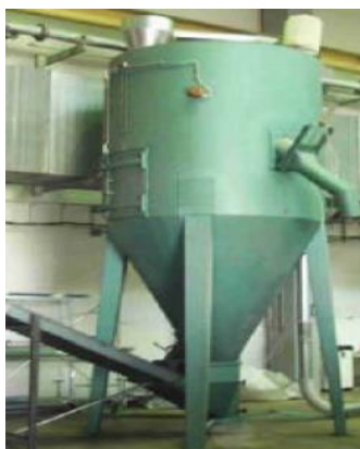
Figura 12. Hidrociclón para la limpieza del PET.
