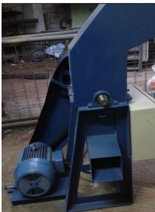
Figura 68. Fabricación: tolvas de carga, descarga y protectora de bandas y poleas.
