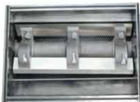
Figura 18. Cámara de corte del molino triturador de plásticos con rotor abierto.
