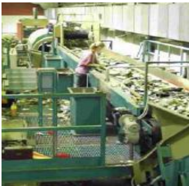
Figura 5. Banda transportadora para separación manual de PET
