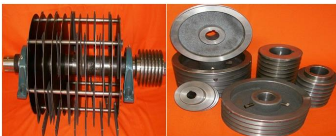
Figura 9 . Eje rotatorio, un par de chumaceras y poleas.
