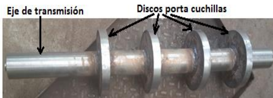
Figura 64. Cámara de corte: eje de transmisión – discos porta cuchillas.
