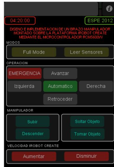
Figura 8. HMI teléfono inteligente – TouchOSC
