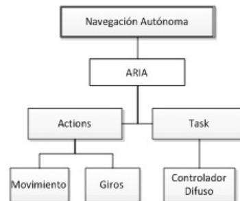
Figura 24. Esquema de funciones del programa de Navegación Autónoma
