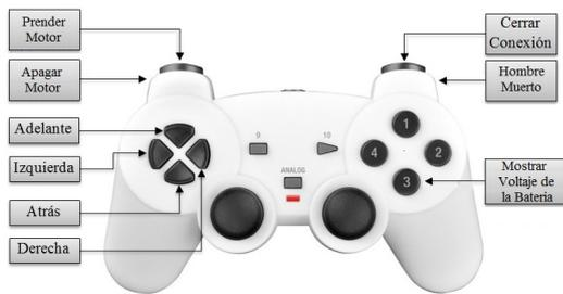
Figura 21. Configuración de Mando para la aplicación TelVeMap
