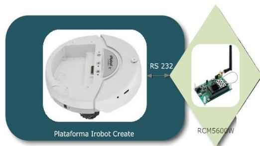
Figura 4. Comunicación Irobot Create – RCM5600W
