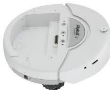
Figura 1. Plataforma móvil Irobot Create
