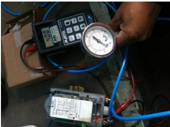
Fig. 16 Calibración del transductor de presión
