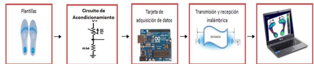
Figura 3. Diagrama de bloques del Hardware
