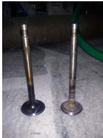
Figura 12 Válvulas después de limpieza
