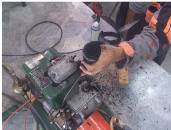
Figura 13 Carbón en el sistema de escape
