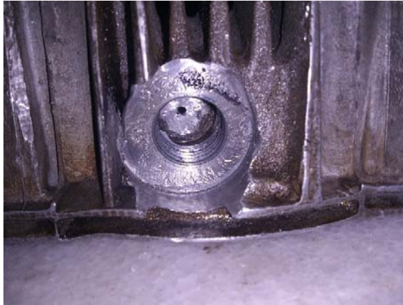
Figura 7 Rosca rectificada motor Diesel
