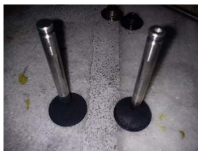
Figura 10 Válvulas antes de limpieza
