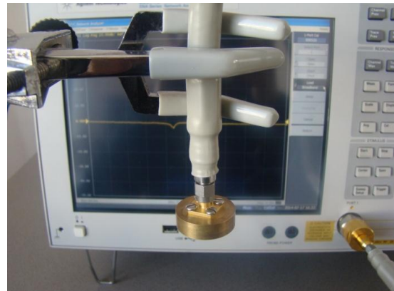
Figura 134. Sonda en el cable RF
