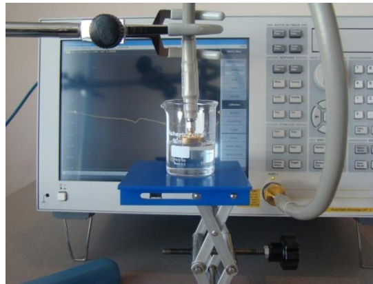
Figura 142. Medición de la sonda en el líquido simulador
