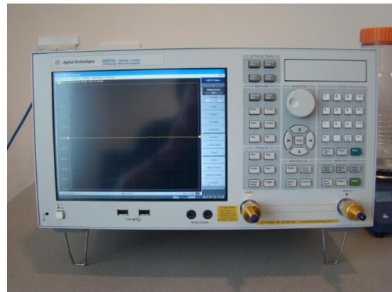
Figura 89. VNA E5071C encendido
