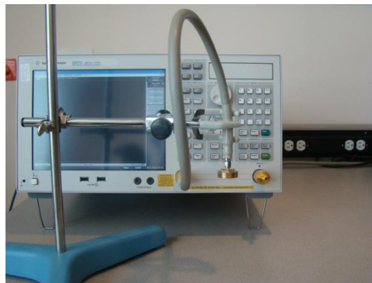
Figura 136. Medición de la sonda en el aire
