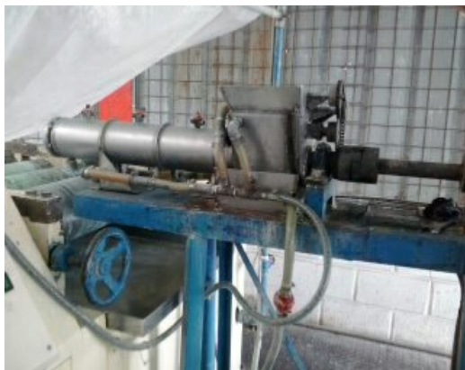
Figura 86. Rodillos sin fin
