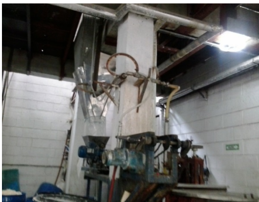
Figura 83. Extrusora de jabón
