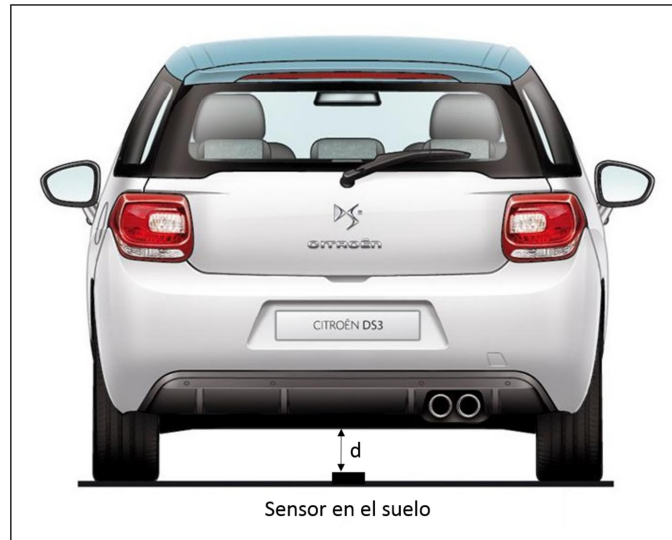
Figura 22: Distancia medida por el sensor.
