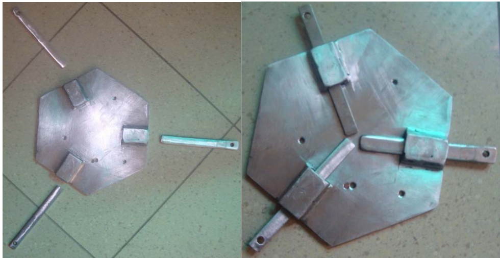
Figura 141 Posición de platinas en base fija
