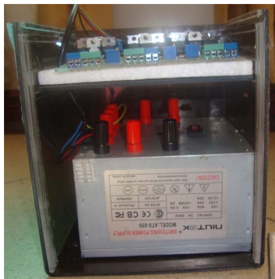
Figura 152. Caja de control y potencia
