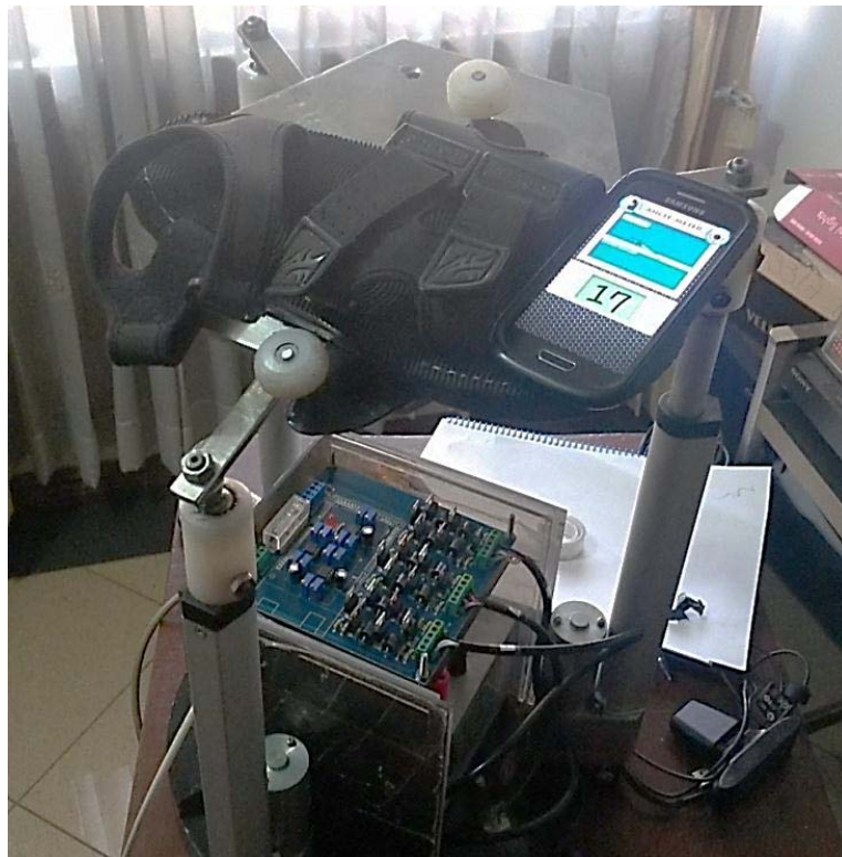
Figura 166. Aplicación Angle Meter para movimiento Eversión Pie Izquierdo
