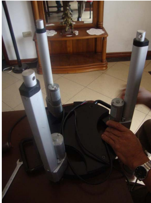
Figura 137. Base fija y actuadores
