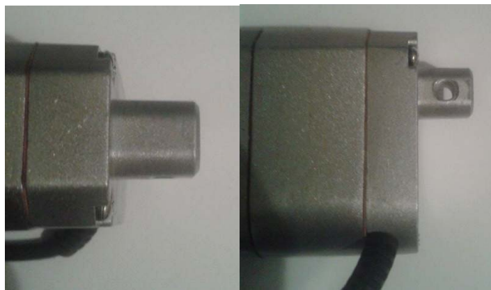
Figura 56. Soporte de montaje del actuador lineal
