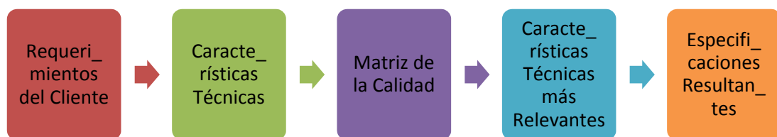
Figura 45. Proceso de obtención para especificaciones de máquina
