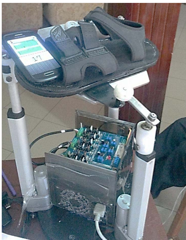
Figura 162. Aplicación Angle Meter para movimiento Eversión Pie Derecho
