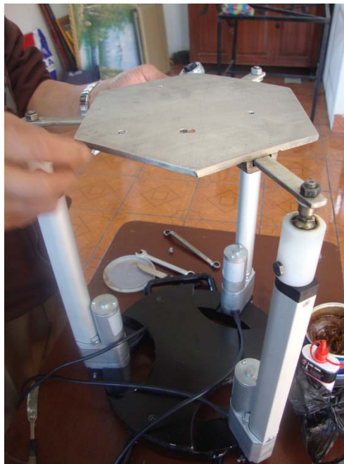
Figura 144. Ensamble base fija y base móvil
