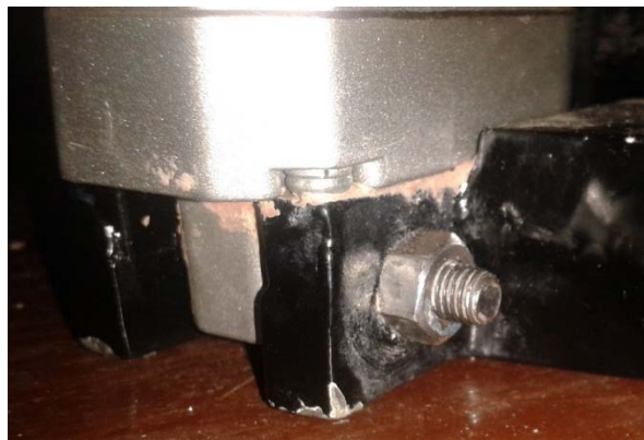
Figura 150. Aplicación de masilla
