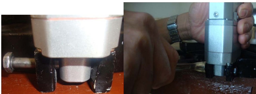
Figura 138. Anclaje de actuador a base fija
