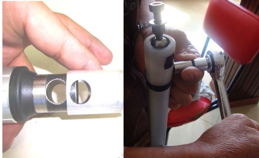
Figura 139. Anclaje y aseguramiento de unión esférica
