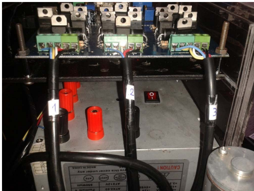
Figura 154. Distribución de los actuadores en la placa electrónica
