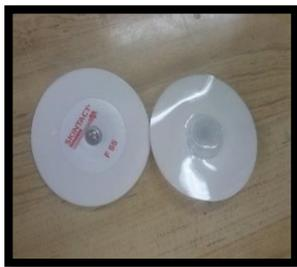
Figura 3: Electrodos Ag/Ag Cl.
