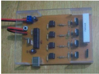
Figura 2. Placa de control y potencia
