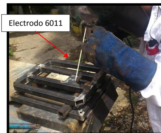
**Figura 4. 2. Proceso de suelda de platinas de celdas de carga**
