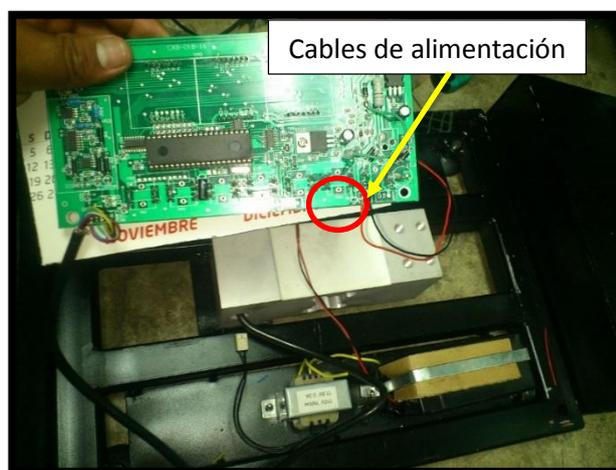
**Figura 4. 20. Unión de los cables de alimentación al indicador**
