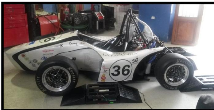
**Figura 4. 30. Pruebas de pesaje con Monoplaza FESPE**
