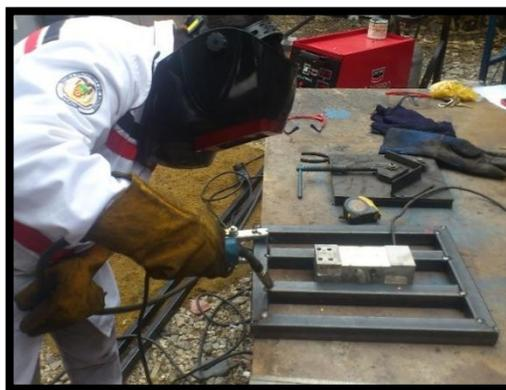
**Figura 4. 3. Sellado de estructuras con suelda MIG**
