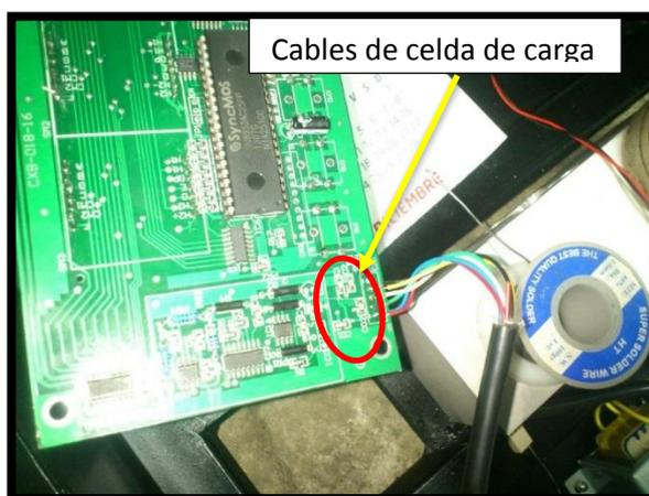
**Figura 4. 19. Unión de los cables de la celda de carga al indicador**
