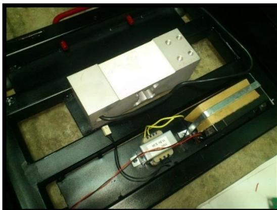
**Figura 4. 18. Sujeción de celda de carga**
