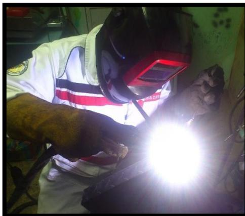
**Figura 4. 4. Sellado de bandejas cobertoras con suelda TIG**
