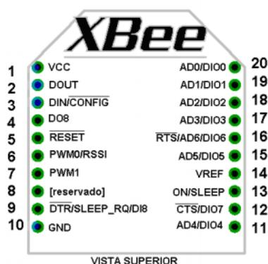
**Figura 4. 11. Diagrama de pines del módulo XBee**
