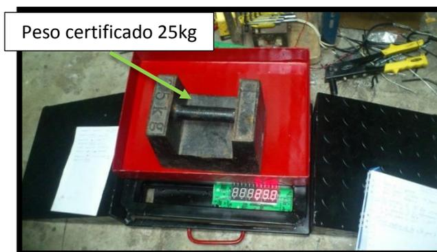
**Figura 4. 25. Calibración de la báscula con un peso de 25 kg**
