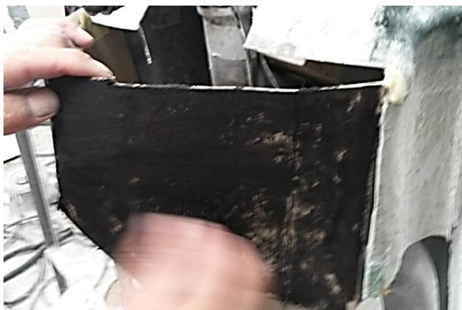
Figura 4. 8: Aplicación de la cera desmoldante en el cartón
