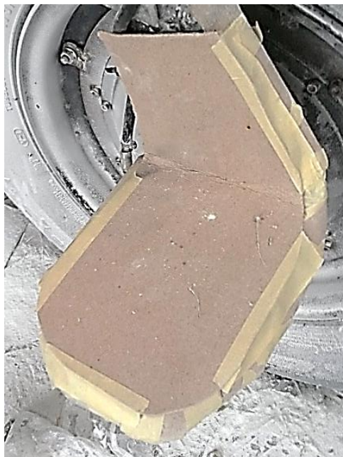
Figura 4. 7: Molde de cartón para los pedales
