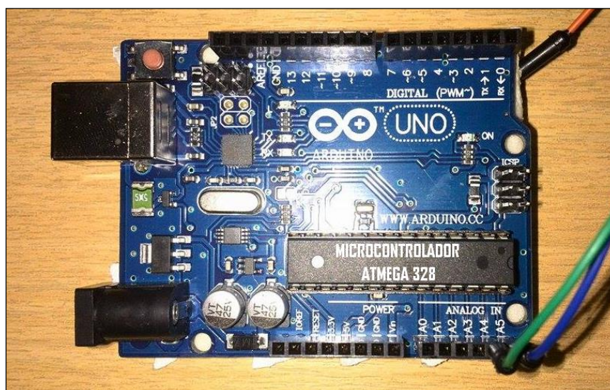
Figura 1. 17: Placa arduino uno con programación libre
