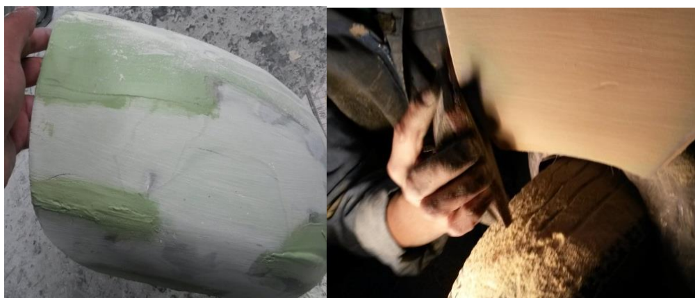
Figura 4. 11: Masillado y lijado de las piezas
