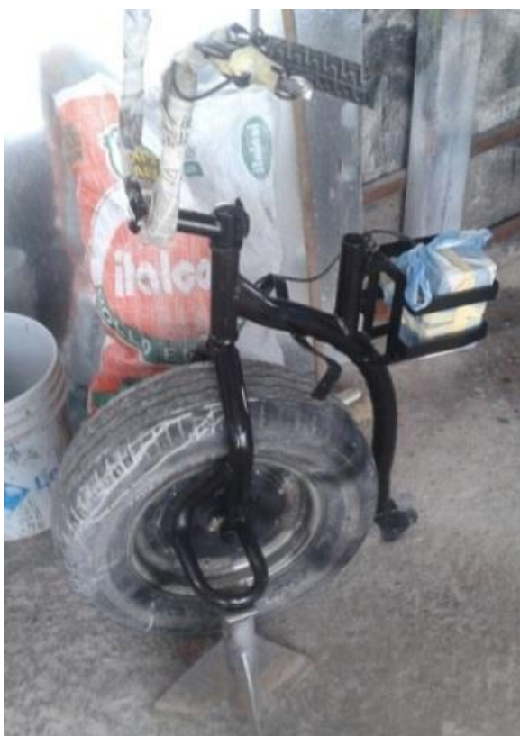
Figura 4. 12: Estructura con pintura anticorrosiva
