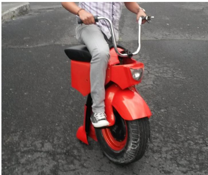
Figura 4. 14: Monociclo eléctrico terminado.
