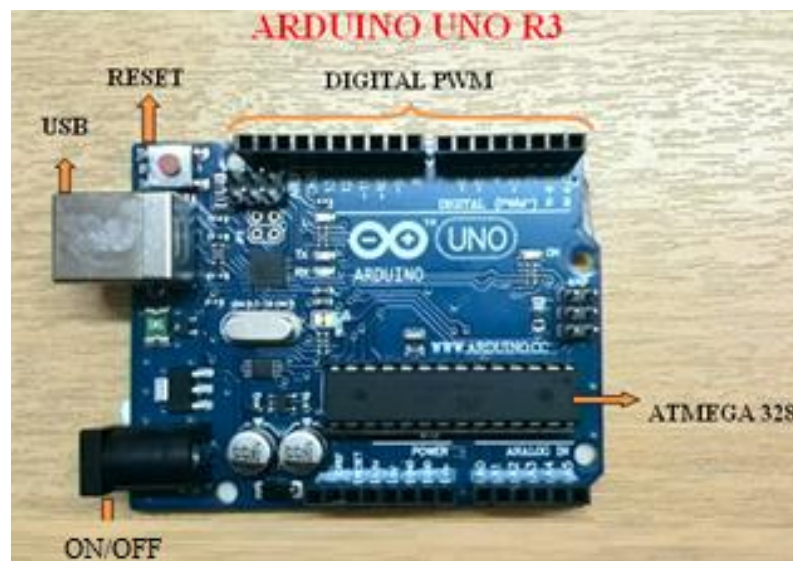
Figura 3. 9: Componentes principales del Arduino uno R3
