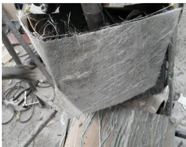
Figura 4. 9: Aplicación de la fibra de vidrio al molde
