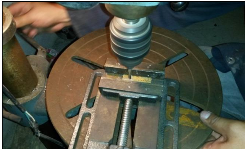
Figura 4. 4: Maquinado de las plaquetas
