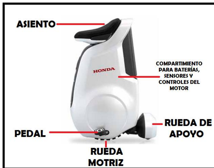
Figura 1. 6: Monociclo eléctrico Honda UNI-CUB Fuente: Honda Worldwide, 2014
