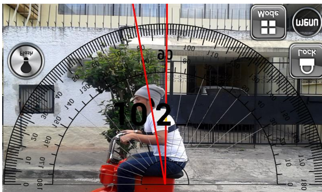
Figura 5. 7: Ángulo de inclinación del conductor
