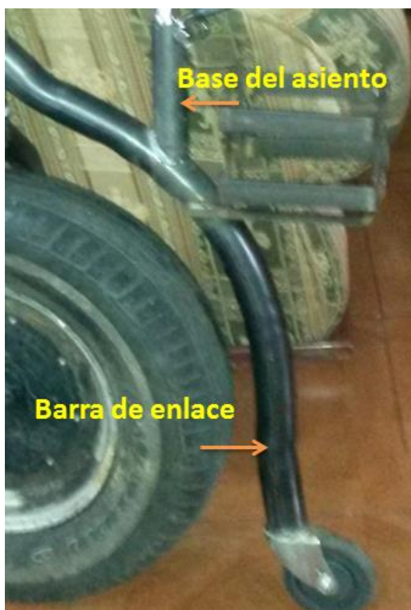
Figura 4. 6: Base del asiento y columna de enlace
