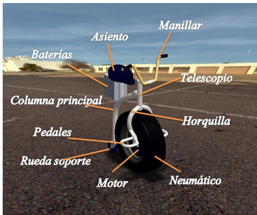
Figura 2. 6: Modelado del chasis
