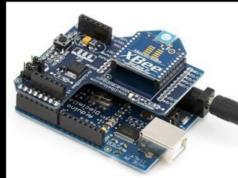
Fig5. Ilustración del montaje de Los Módulos Xbee en el computador y en la tarjeta Arduino
