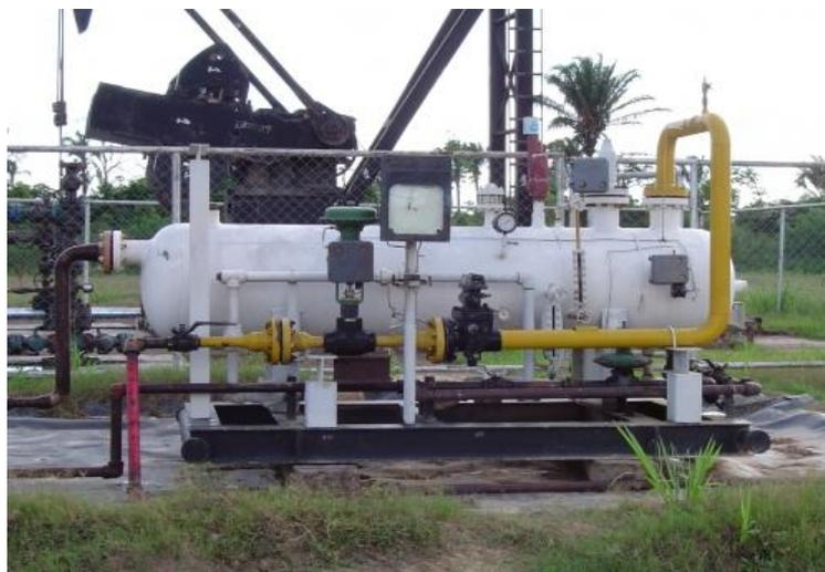
**Figura 1.6 Separador de prueba.**
