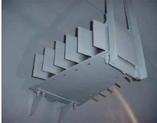
**Figura 2.12 Deflector de entrada del Separador.**
