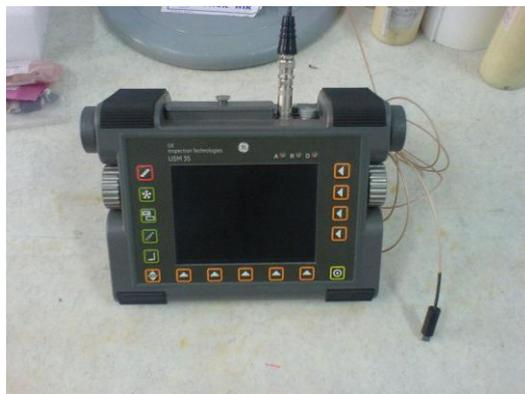
**Figura 2.9 Equipo para pruebas de ultrasonido.**
