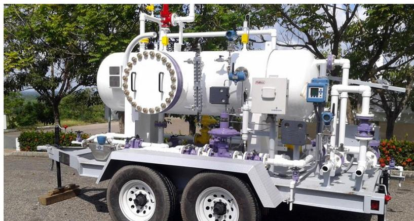
**Figura 1.7 Separador de medición.**
