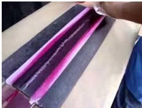
**Figura 2.10 Esparción de líquido penetrante sobre una superficie metálica.**
