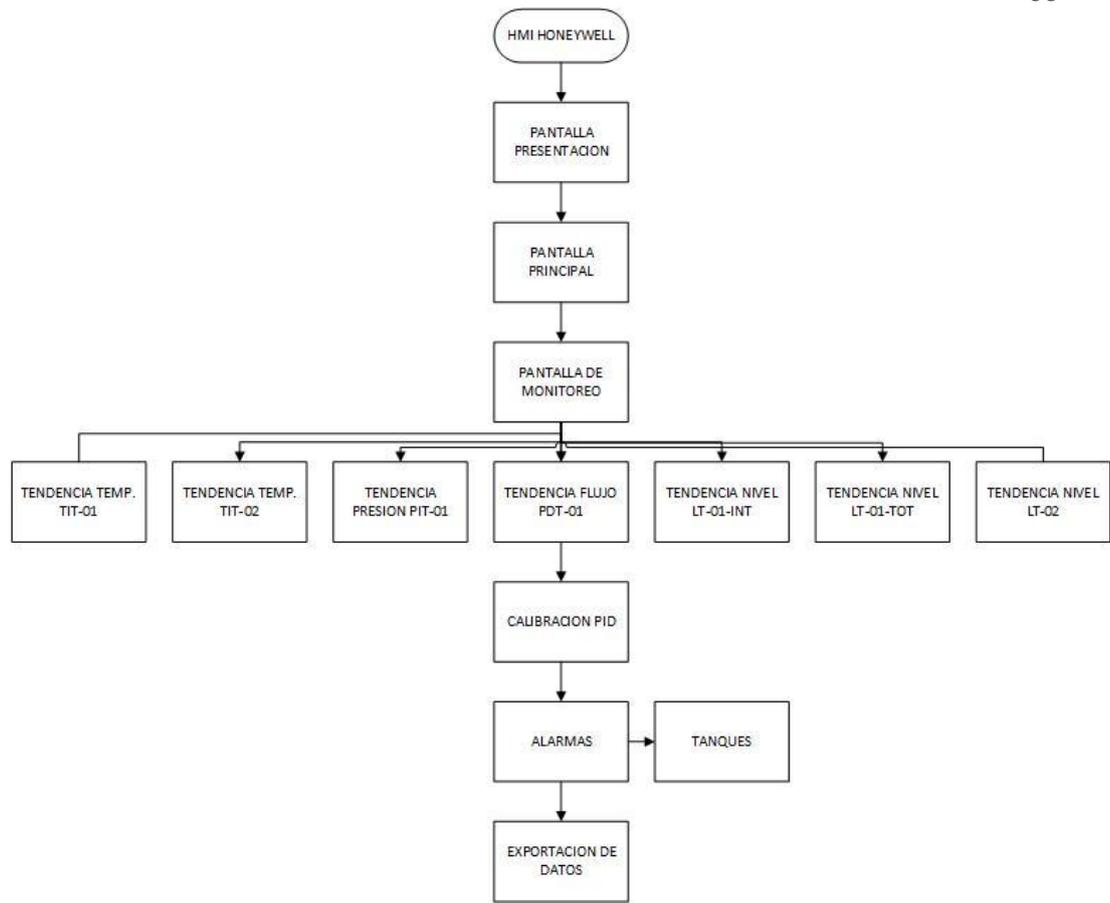
**Figura 3.15 Esquema de interfaz humano máquina**
