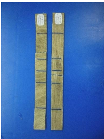
Figura 8. Probetas de material compuesto de fibra continua de cabuya al 30vol% ensayadas.
