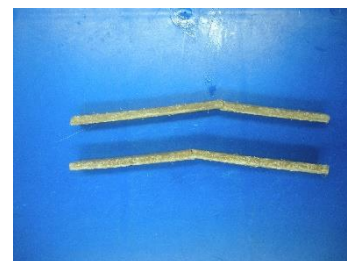
Figura 10. Probetas de material compuesto de fibra continua de cabuya al 30vol% ensayadas a flexión.
