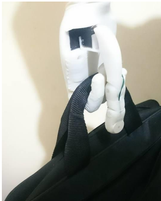
Figura 4.5 Prueba de agarre de gancho
