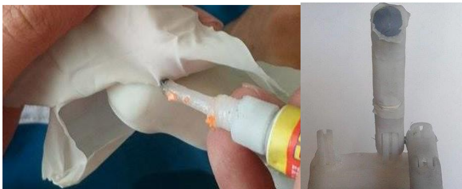
Figura 3.25 Elaboración de fundas contenedoras de material magnetoreológico
