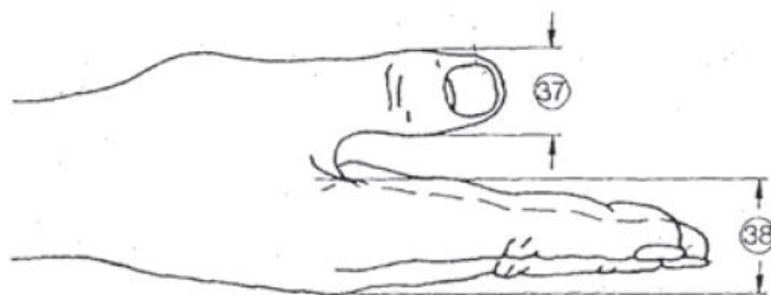
Figura 2.3 Medidas del grosor de la mano y pulgar según la Norma DIN 33 402-2
