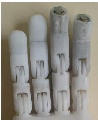
Figura 3.19 Ubicación de los sensores de presión
