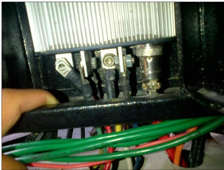
**Figura 64** Conexión del motor-controlador-circuito de control-batería
