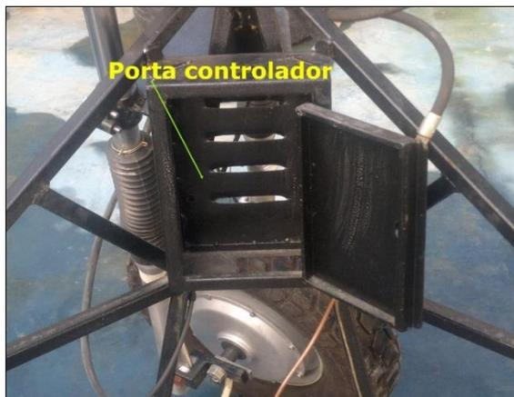
**Figura 58** Caja base para la colocación del controlador
