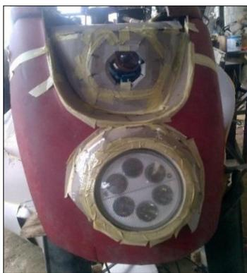
**Figura 66** Instalación de las luces led Delanteras
