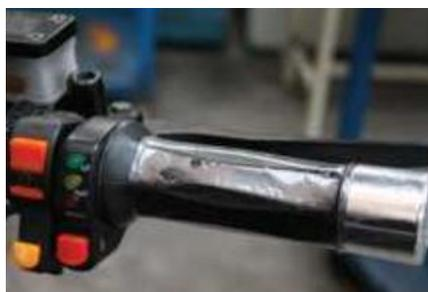
**Figura 28 Acelerador para motor eléctrico**
