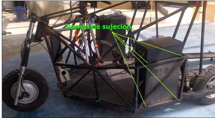
**Figura 55 Sujeción y disposición del porta-baterías**
