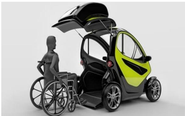
**Figura 14 Triciclo eléctrico para discapacitados**
