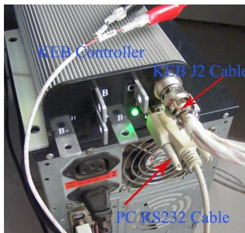
**Figura 26 Conexión del KEB Controller al Pc mediante el cable RS232**
