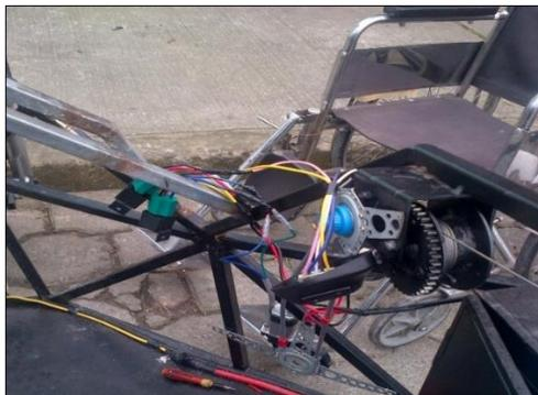
**Figura 68** Instalación eléctrica mecanismo del sistema de acceso
