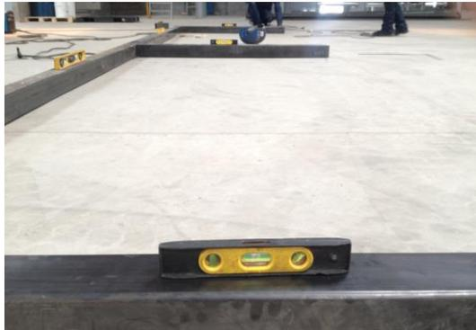
*Figura 70. Verificación de partes antes de ensamblar*
