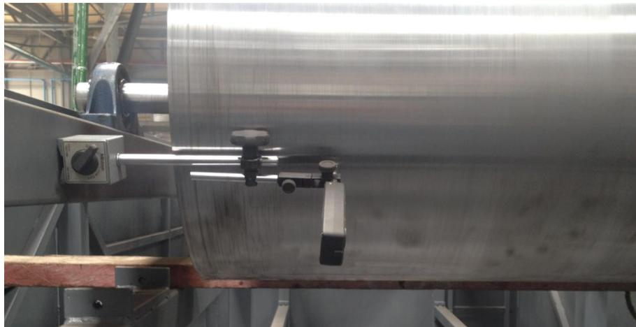
*Figura 118. Verificación del rectificado de los rodillos*
