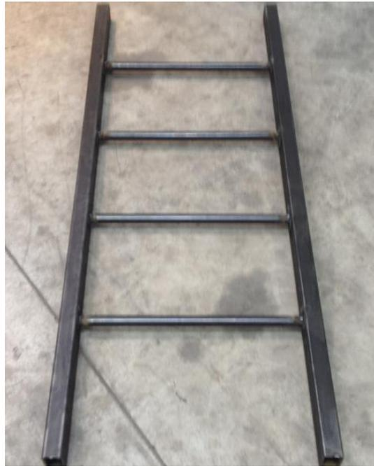
*Figura 88. Elaboración de gradas de acceso internas*
