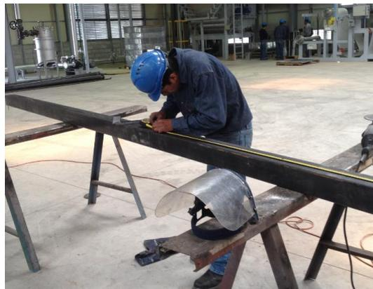
*Figura 66. Verificación de medidas y trazado en perfiles*
