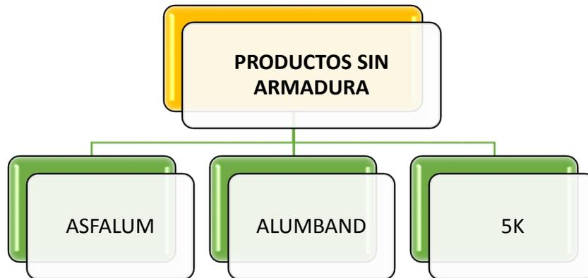
**Asfalum:** Son láminas prefabricadas, a base de asfaltos modificados con polímeros elastoméricos tipo SBS y cargas minerales. Contiene en la cara inferior polietileno antiadherente y termofusible para la aplicación con soplete a gas, y en la cara superior contiene foil de aluminio de 80 micras que actúa como autoprotección de la lámina a la exposición de la radiación ultravioleta del sol.
