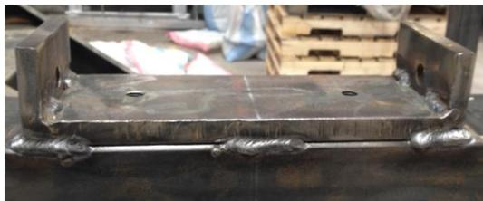
*Figura 85. Reforzada en la soldadura en los soportes de chumaceras*
