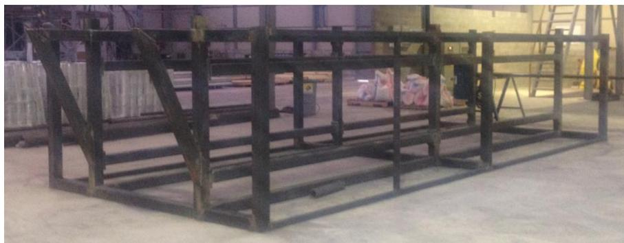
*Figura 81. Bastidor y cuartos de máquinas*
