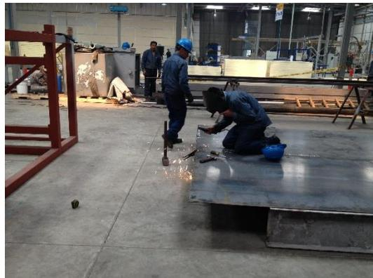
*Figura 97. Soldadura de plancha naval piso*
