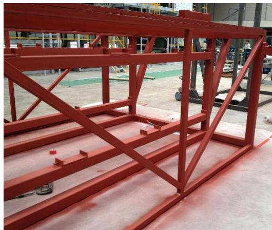
*Figura 92. Estructura metálica pintada con pintura anticorrosiva*
