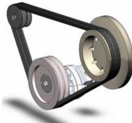
*Figura 18. Sistema de transmisión por bandas*
