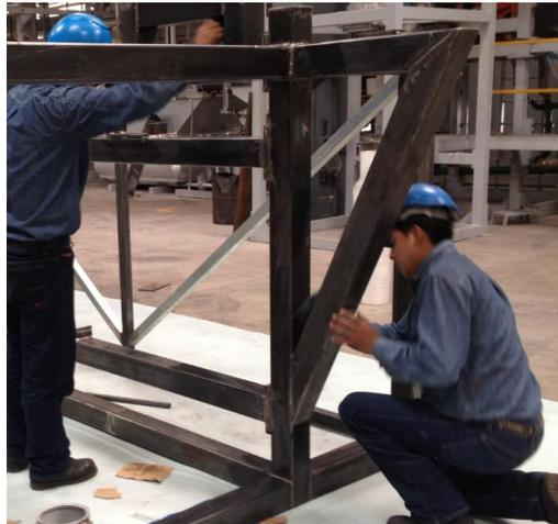
*Figura 90. Limpieza de la estructura por medio de gasolina*
