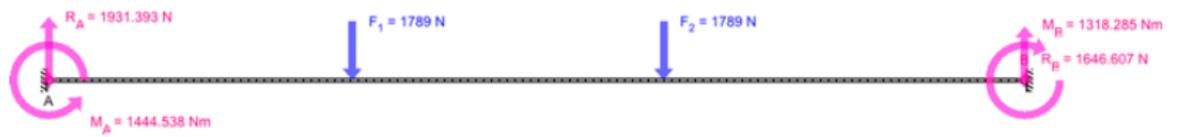
Figura 48. Diagrama de reacciones Viga 4
