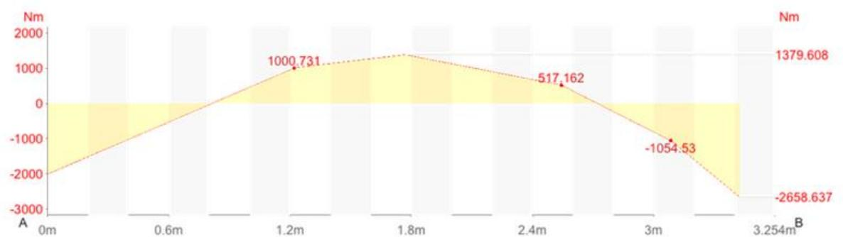
Figura 32. Diagrama de momentos Viga 1
