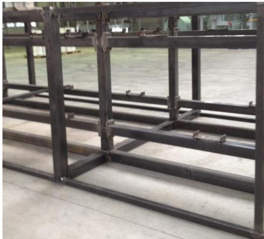
*Figura 84. Colocación de soportes de chumaceras en el bastidor*
