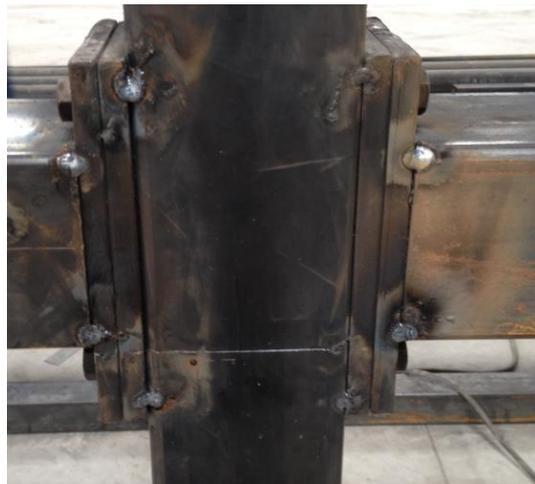
*Figura 74. Punteada de placas empernadas del bastidor*
