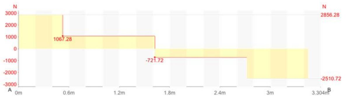
Figura 37. Diagrama de fuerzas Viga 2
