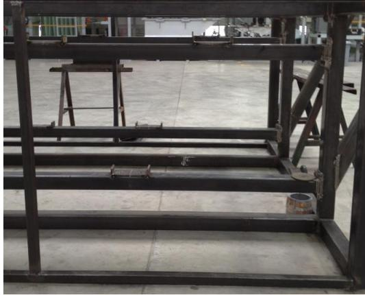
*Figura 83. Trazado de soportes de chumaceras en el bastidor*
