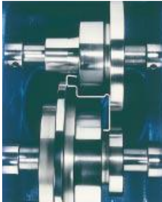
Figura 18. Forma compleja obtenida por perfilado
