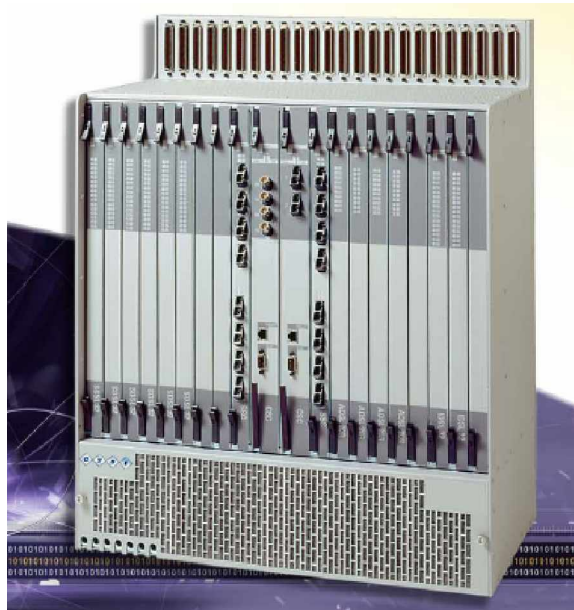
Figura 5.13 DSLAM de Acceso Universal Edge IMAS Nortel
