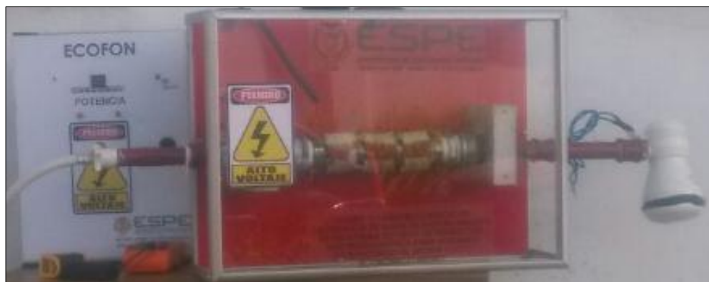
Figura 74 Sistemas Integrados, prototipo de calentamiento de agua por inducción electromagnética
