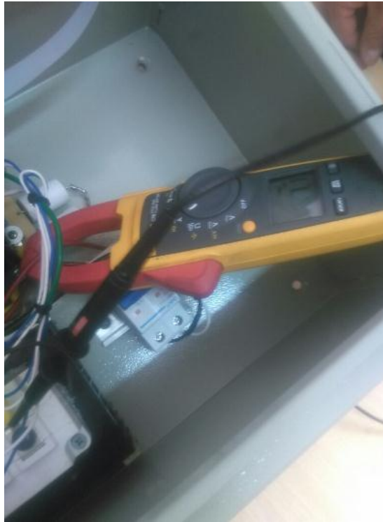
Figura 75 Medición de corriente de entrada prototipo de calentamiento de agua de inducción electromagnética
