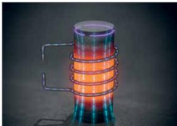
Figura 3 Representación de corrientes de Foucault
