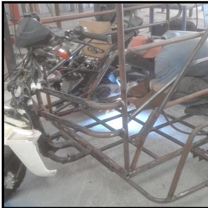
**Figura 154,** Complemento de soldadura en el sistema estructural y refuerzos
