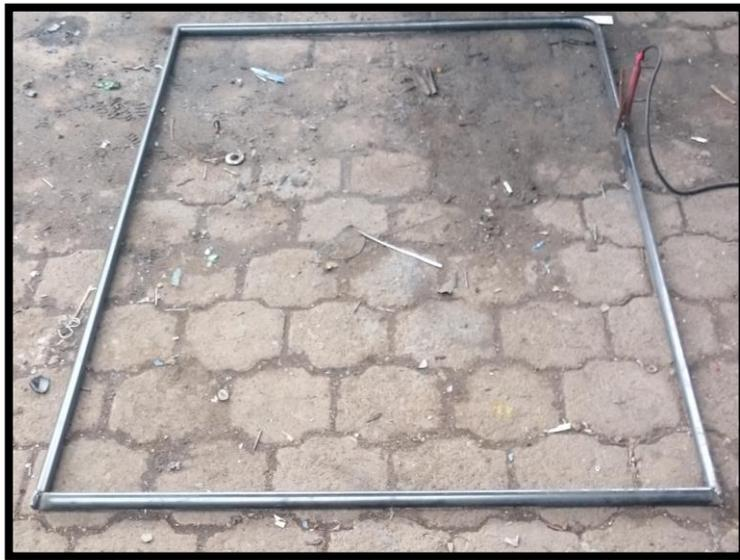
**Figura 136,** Unir las partes biseladas con soldadura
