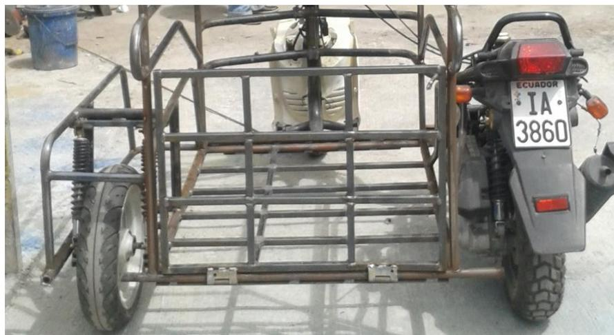
**Figura 32,** Descripción Gráfica configuración Sistema Motriz.
