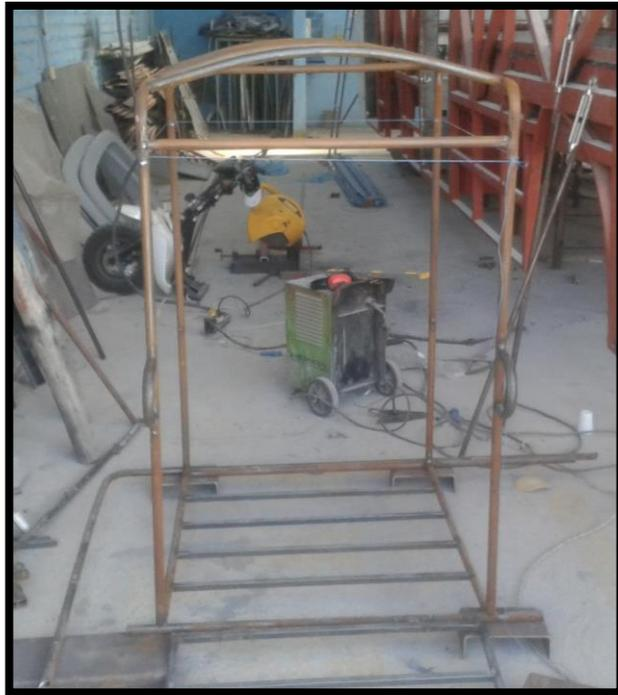
**Figura 142,** Verificar las medidas exteriores de la estructura principal
