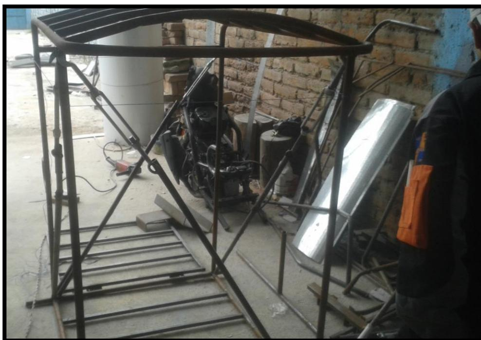
**Figura 144,** Soldar los tensores en las diagonales principales
