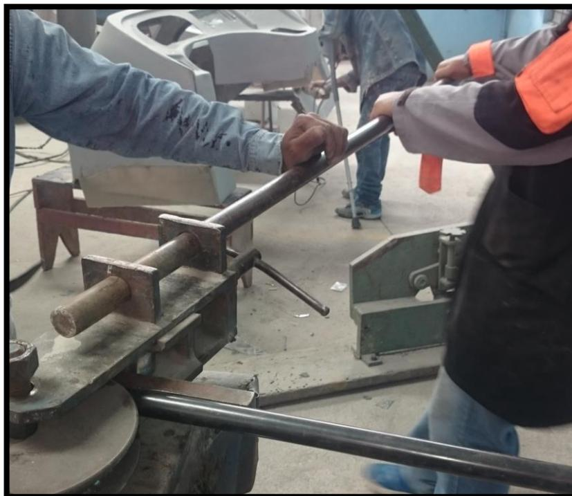
**Figura 127,** Forma de aplicar fuerza en la dobladora manual.
