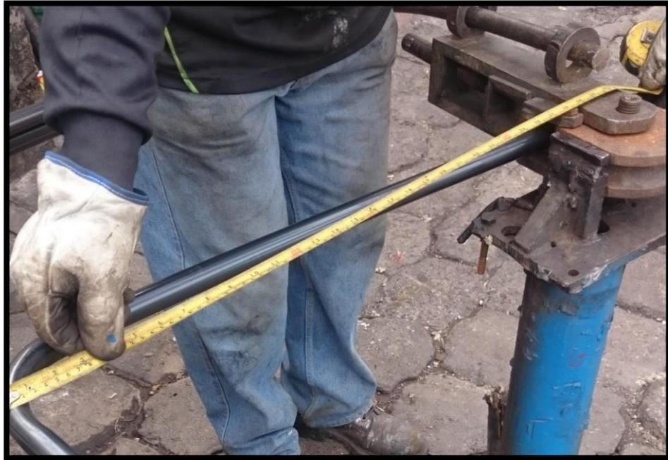
**Figura 132,** Verificación de medidas después del doblado
