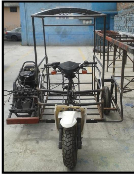
**Figura 155,** Vista frontal de finalización de soldadura en el sistema estructural
