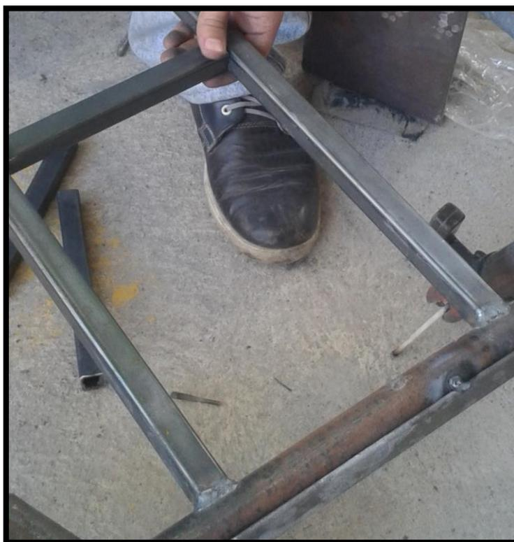
**Figura 134,** Ensamble de partes con boca de pescado.
