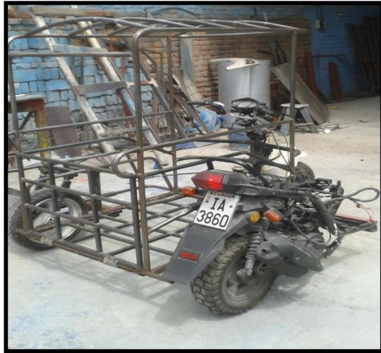
**Figura 157,** Finalización de soldadura en el sistema estructural vista desde una perspectiva posterior
