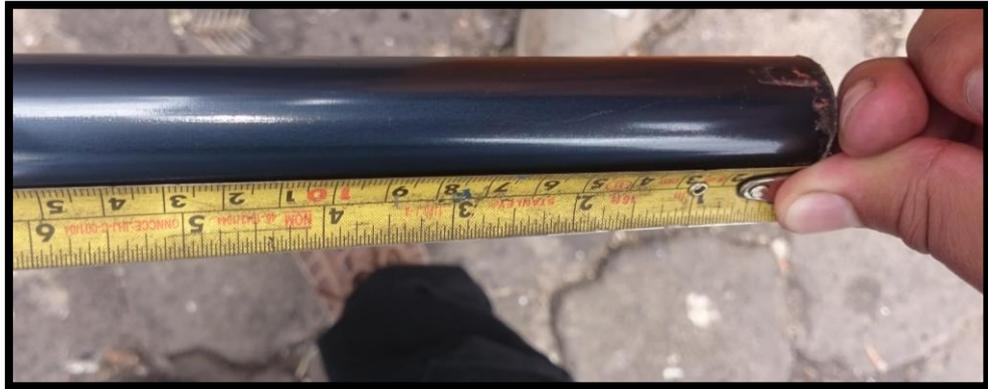
**Figura 118,** Trazo de la medida del perfil tubular para corte
