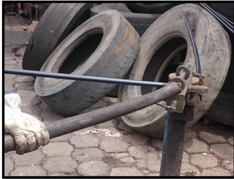
**Figura 130,** Aplicación de la fuerza en la dobladora manual
