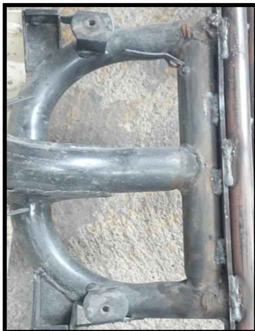
**Figura 148,** Unión del sistema de dirección al sistema estructura
