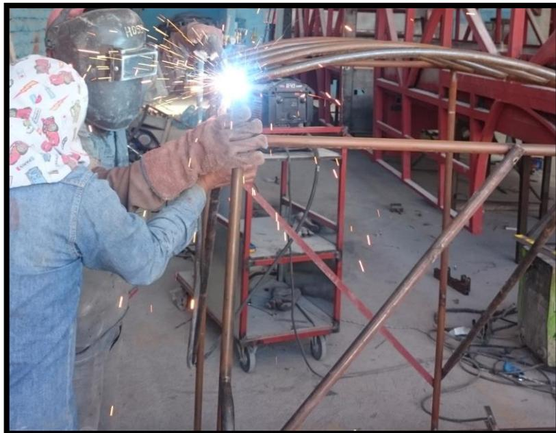
**Figura 146,** Complemento de soldadura en la estructura principal mediante soldadura MIG
