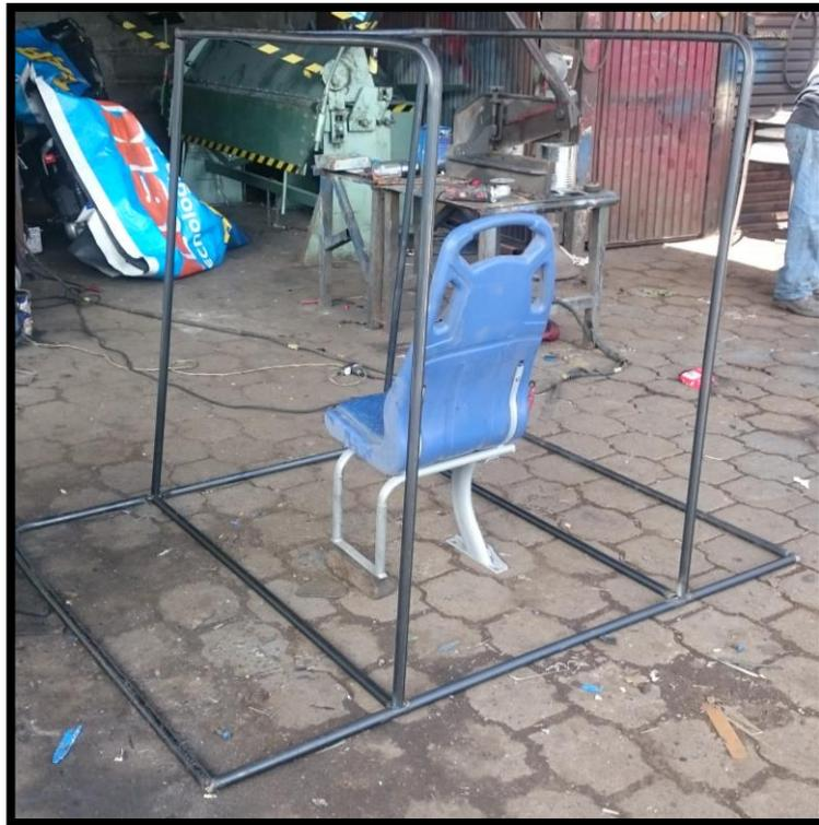
**Figura 138,** Estructura externa techo y bases para la tercera llanta, fijación de motoneta
