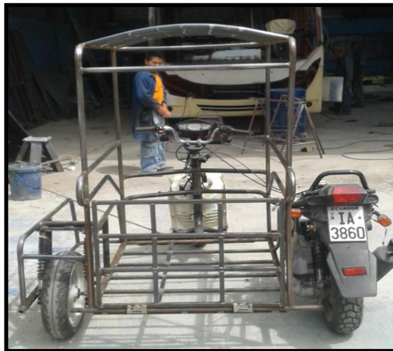
**Figura 158,** Vista posterior de finalización de soldadura en el sistema estructural
