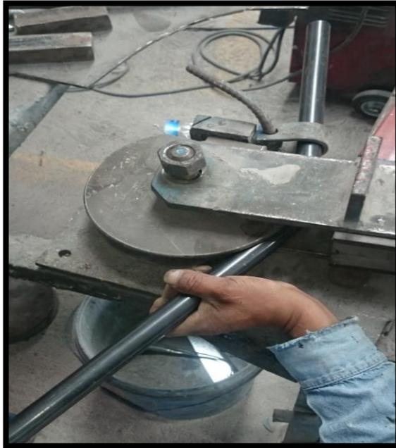
**Figura 126,** Forma de doblado de un perfil tubular circular
