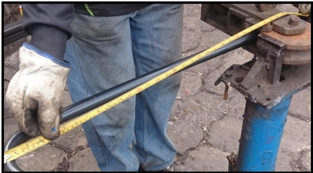
**Figura 119,** Trazo de la medida del perfil tubular para doblado
