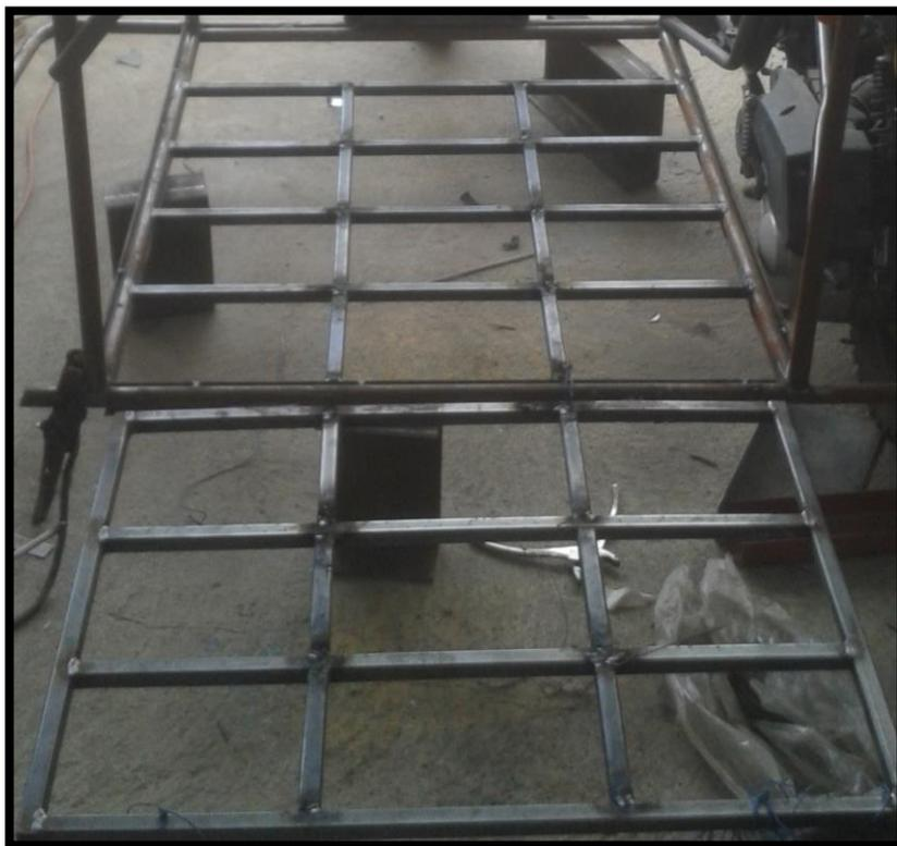
**Figura 147,** Colocar los refuerzos en el piso y la rampa
