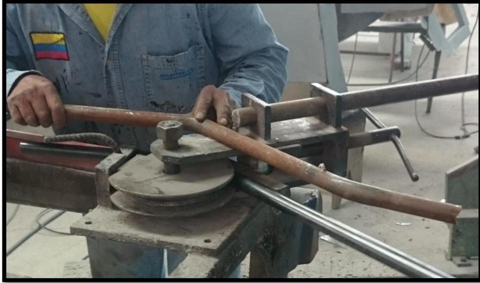
**Figura 128,** Matriz utilizada para el doblado de perfil tubular circular.
