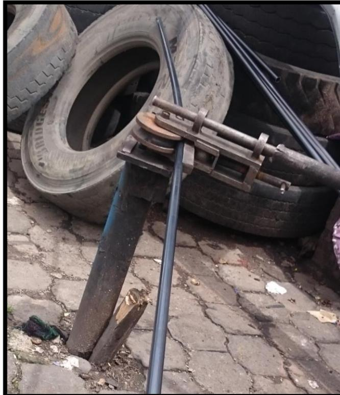
**Figura 129,** Posicion del perfil tubular en la dobladora manual
