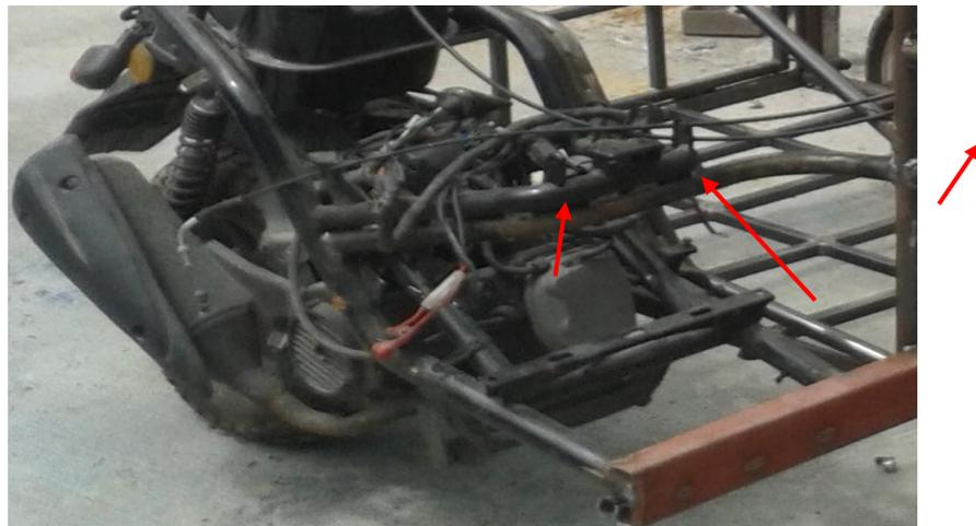
**Figura 33,** Descripción Gráfica Anclaje delantero superior
