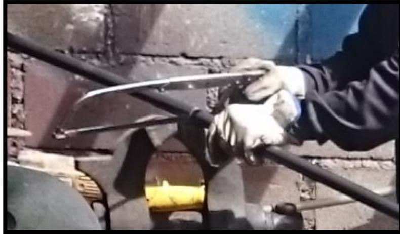
**Figura 120,** Corte manual del perfil tubular circular
