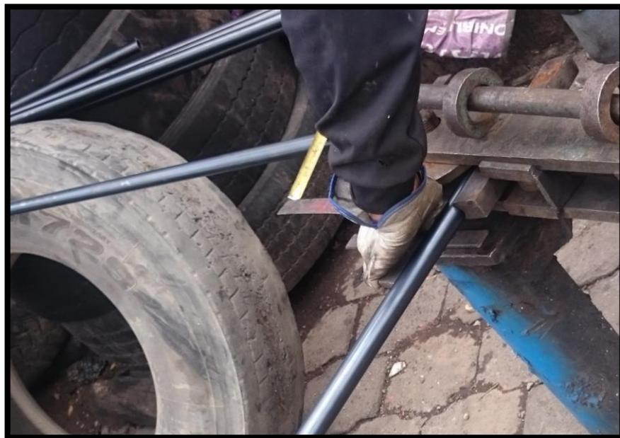
**Figura 131,** Verificación del doblado en la maquina manual
