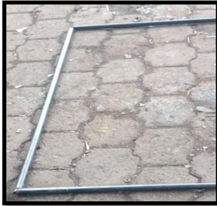
**Figura 135,** Unión de partes mediante biselado a 45 grados
