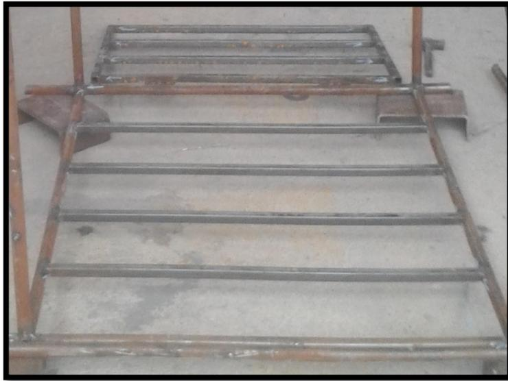
**Figura 141,** Colocar los travesaños en el piso y la rampa
