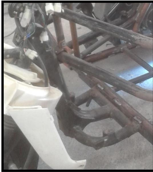
**Figura 149,** Fijación mediante soldadura del sistema de dirección al sistema estructural
