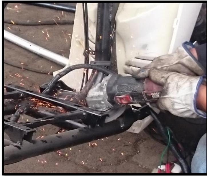
**Figura 122,** Corte de proteccion del chasis de la moto
