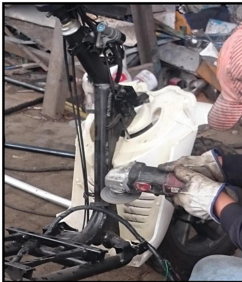
**Figura 121,** Corte del chasis mediante amoladora.
