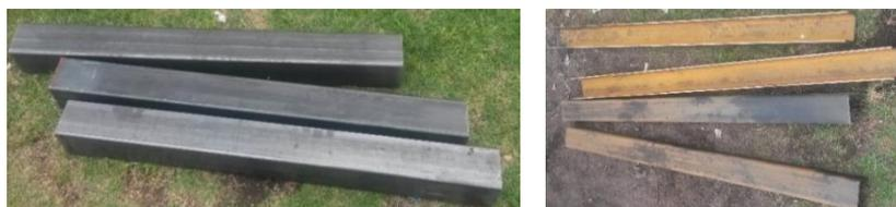
**Figura 70 Corte de perfiles según dimensiones establecidas.**
