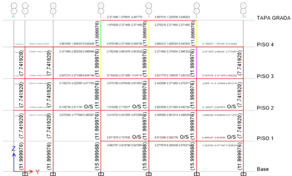
Figura 18 Elementos que fallaron Pórtico C
