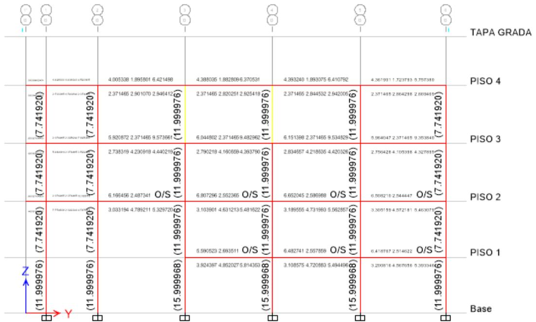
Figura 17 Elementos que fallaron Pórtico B
