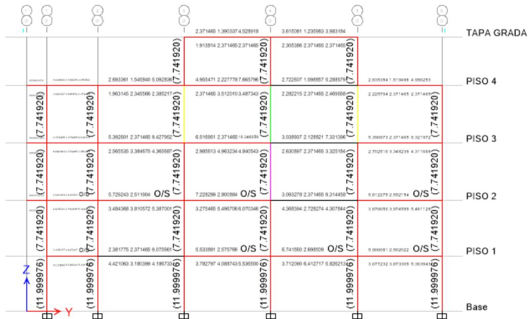
**Figura 19 Elementos que fallaron Pórtico D**
