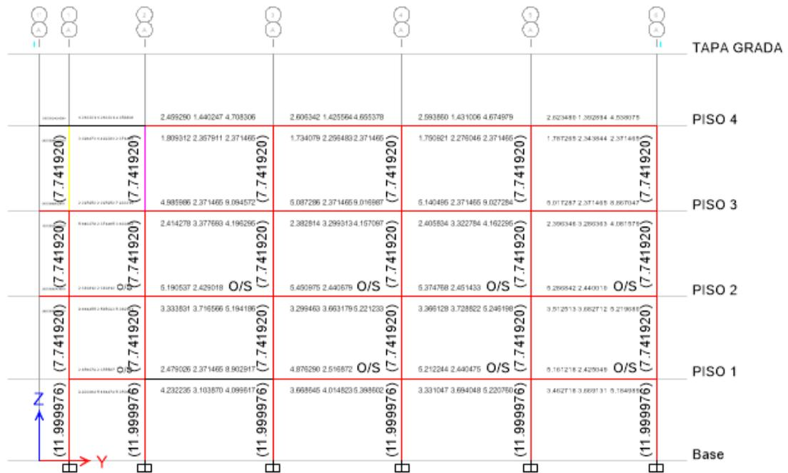
Figura 16 Elementos que fallaron Pórtico A
