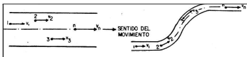
Figura 7 Trayectoria de las partículas en un flujo laminar.
