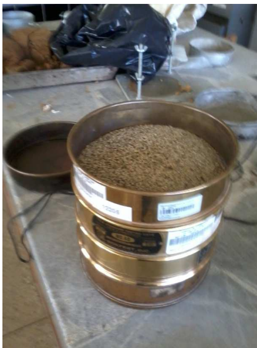
Figura 59 material retenido por tamices
