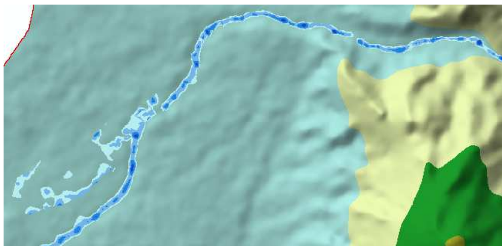
Figura 78 Simulación de la inundación de un tramo del río Cristal cercano a Montalvo.
