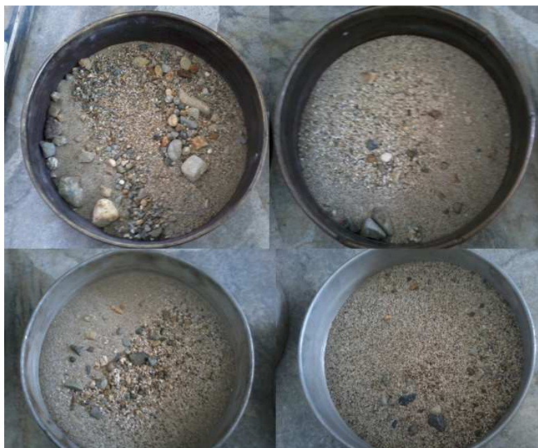
Figura 57 Muestras después de secar al horno.
