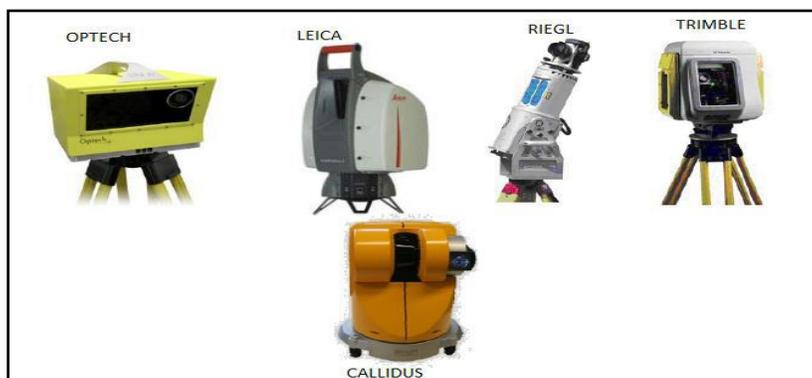
**Figura 7 Ejemplos de scanners basados en tiempo de vuelo**
