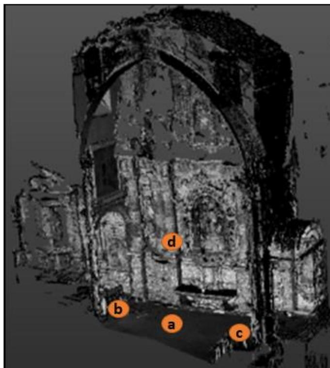
**Figura 66 Posicionamiento de las estaciones de escaneo**
