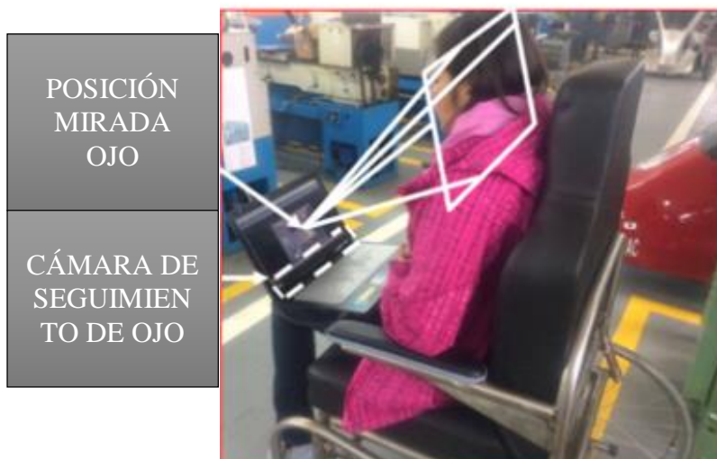
Figura 67: Representación de la interacción entre la interfaz hombre-máquina y el usuario
