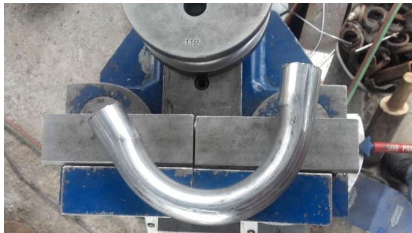
Figura 57. Dobles de tubo mediante dobladora hidráulica.
