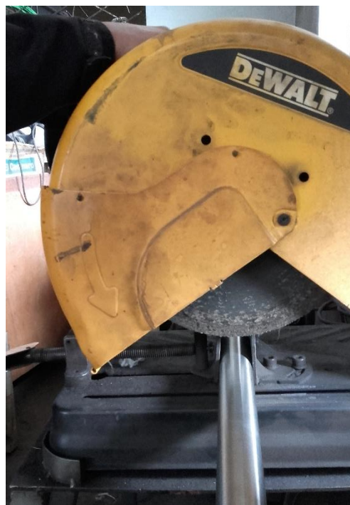
Figura 55. Corte de tubo de acero inoxidable.
