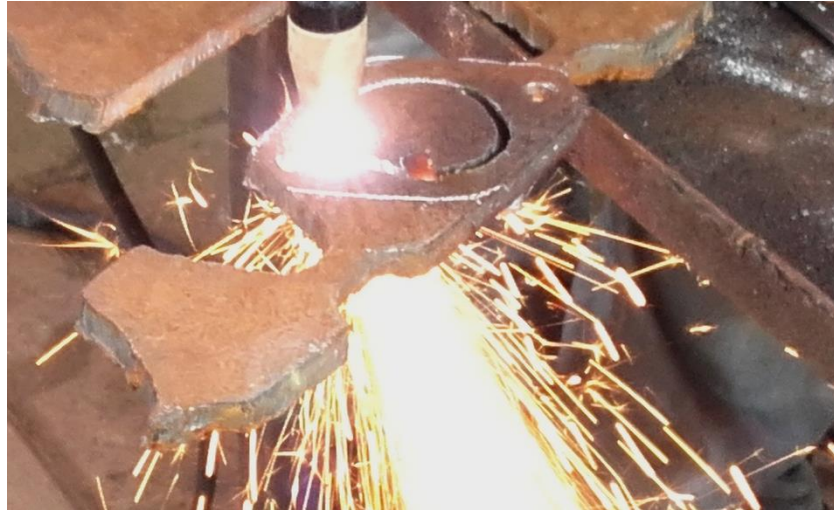
Figura 56. Corte en la plancha de acero inoxidable.
