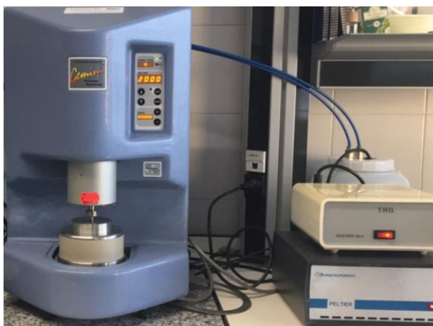
Figura 32 Reómetro Gemini Advanced, laboratorio de Reología-Universidad de Málaga
