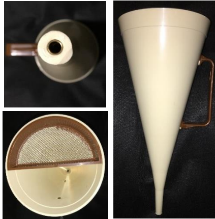
Cono de Marsh – API 13B-1 (Vistas frontal, superior en inferior)
