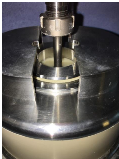
Capa de aceite mineral, encima de la suspensión a temperatura de perforación
