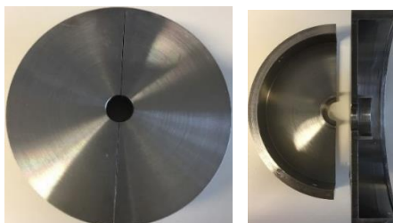
Figura 34 Solvent trap utilizado en la experimentación
